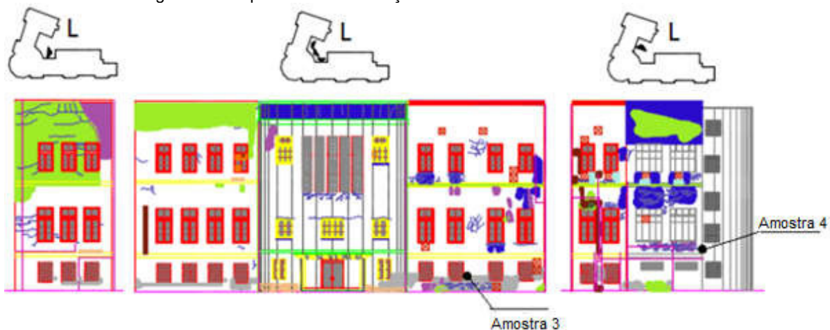
Figura 4 - Croqui do local de extração das amostras 3 e 4 na fachada leste
