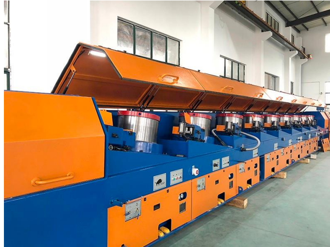
Figura 7. Banc de trefilat múltiple
