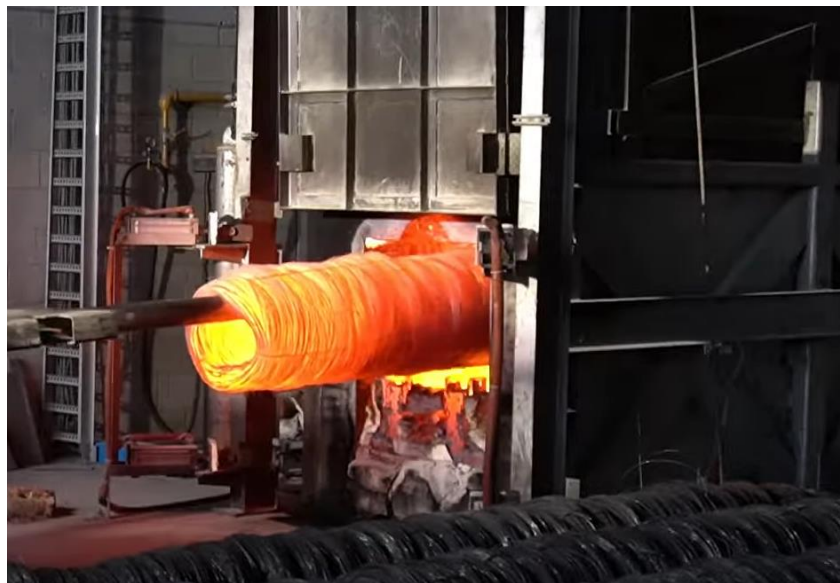
Figura 17. Bobines de fil essent tractades tèrmicament
