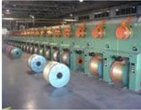
Figura 8. Banc de trefilat múltiple d'acumulació
