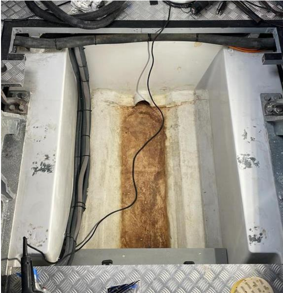
Figura 34: Forat on va instal·lar l'estabilitzador
