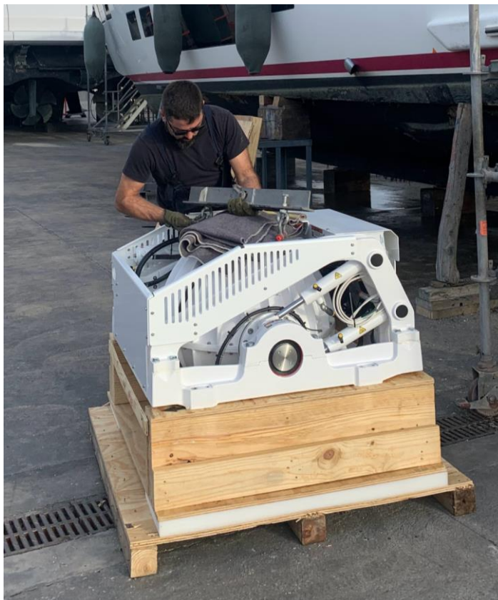
Figura 48: Col·locació de la barra de tensió a les anelles del Seakeeper
