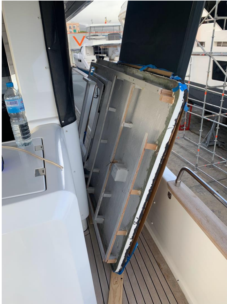
Figura 31: Imatge del registre fora el dia de l'operació de la instal·lació del Seakeeper
