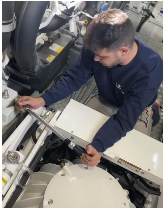
Figura 52: Autor collant els cargols amb la clau dinamomètrica
