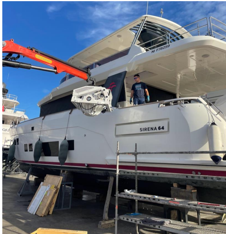
Figura 49: Seakeeper elevat a punt d'entrar dins l'embarcació Font: pròpia
