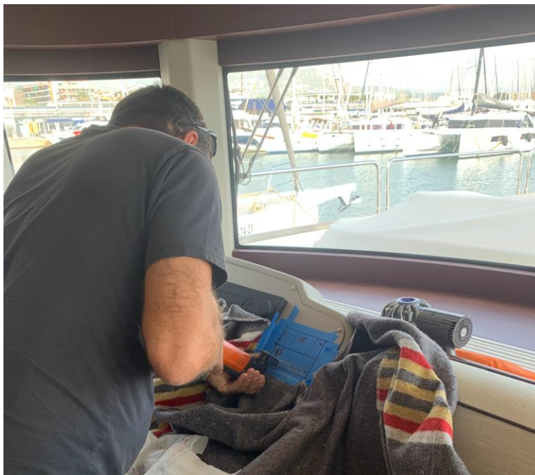
Figura 40: Imatge retallant el govern amb la serra oscil·ladora
