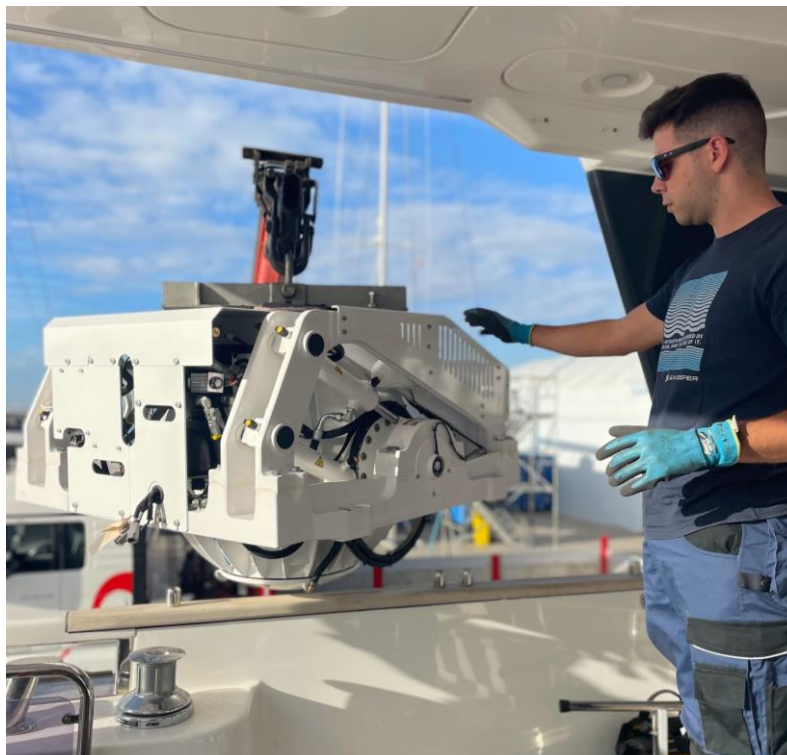
Figura 50: Seakeeper entrant per la banyera de l'embarcació amb la grua Font: pròpia
