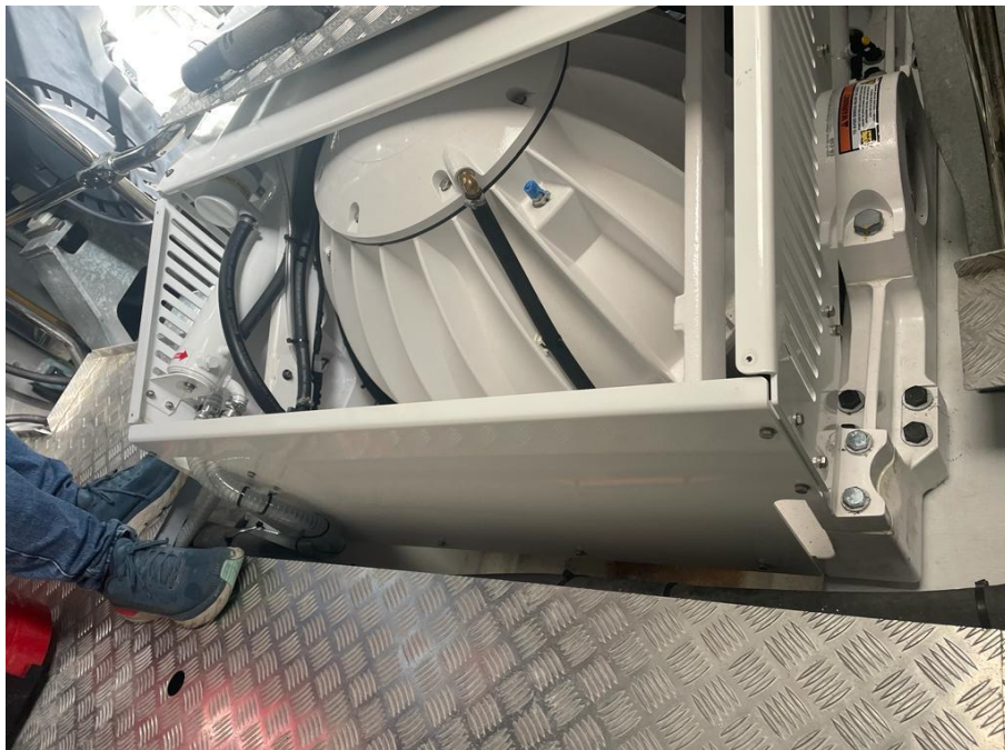
Figura 53: Seakeeper amb els tubs col·locats a l'intercanviador
