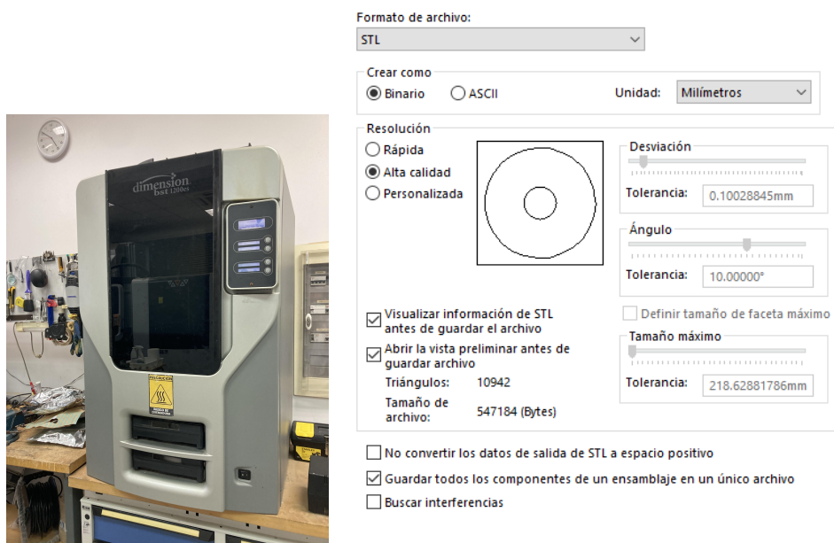
(a) 3D printer used for the modelling, Dimensión 1200es .
