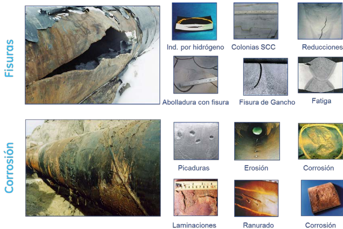
Gráfico 1: Distintos tipos de anomalías presentes en una tubería.
