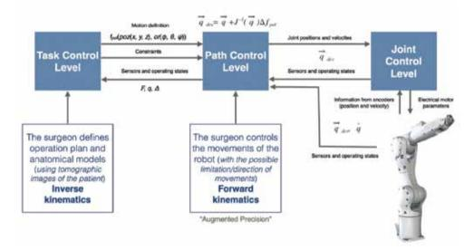
Figure 16. Robot control levels *Slika* 16. Robotske upravljačke razine
