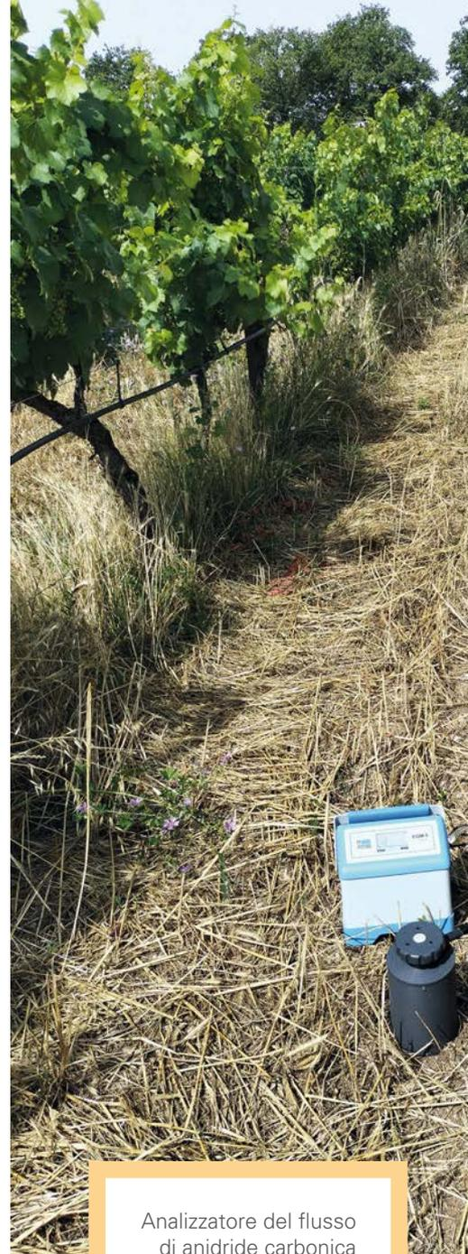
Analizzatore del flusso di anidride carbonica emessa dal suolo per la misura della respirazione
