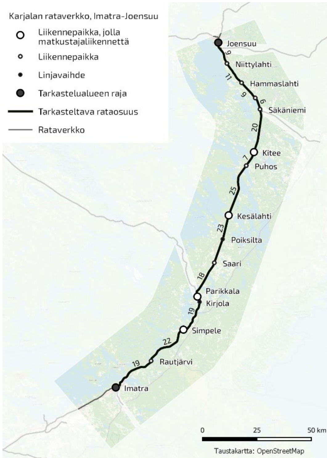
Kuva 2. Imatra–Joensuu-yhteysväli liikennepaikkoineen ja linjavaihteineen. Kartassa on esitetty liikennepaikat ja linjavaihteet niiden välisine etäisyyksineen (Väylävirasto 2023a).
