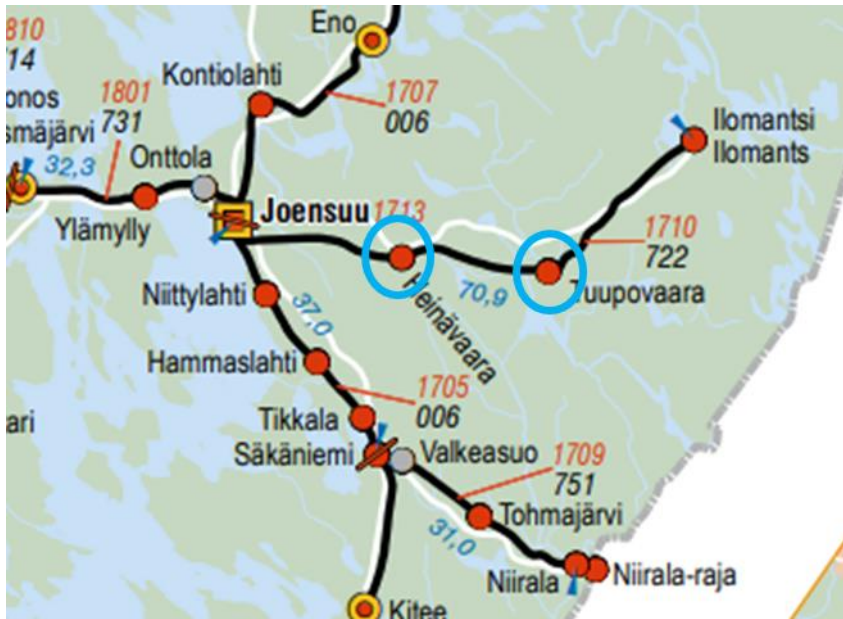
Kuva 33. Heinävaaran ja Tuupovaaran liikennepaikkojen sivuraiteen päällysrakenne on suositeltavaa uusia, mikäli raakapuuliikenne kasvaa selvästi.
