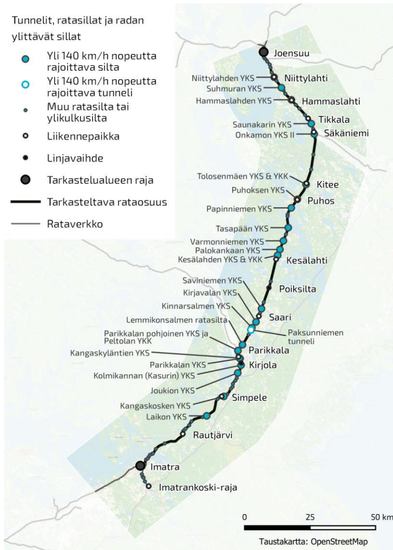
Kuva 10. Imatra–Joensuu-yhteysvälin nopeudennostoa yli 160 km/h rajoittavat ylikulkusillat ja Paksunniemen tunneli.
