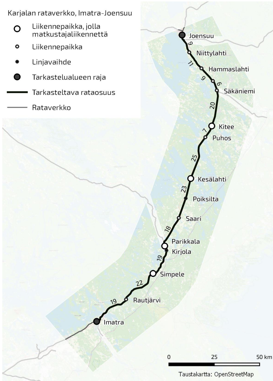
Kuva 2. Imatra–Joensuu-yhteysväli liikennepaikkoineen ja linjavaihteineen. Kartassa on esitetty liikennepaikat ja linjavaihteet niiden välisine etäisyyksineen.
