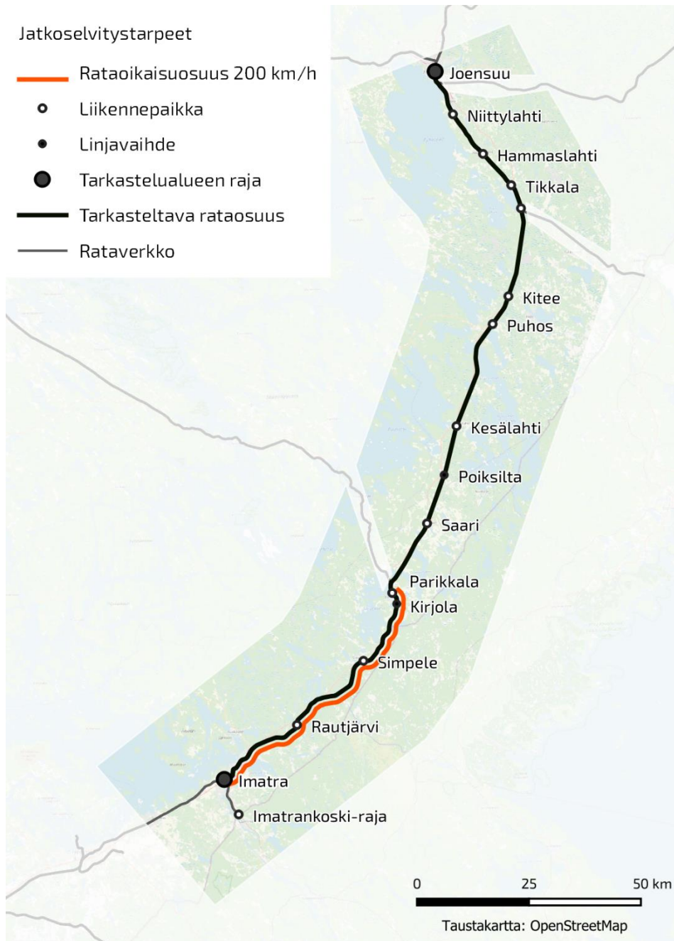
Kuva 30. Ratalinjaukseen tarvittavat muutokset nopeustason 200 km/h saavuttamiseksi. Nopeustaso 200 km/h edellyttää täysin uutta ratalinjaa osuudelle Imatra–Parikkala.
