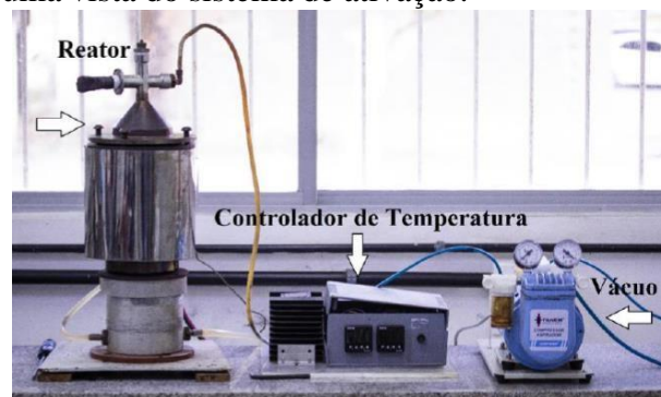
Figura 2: Sistema de ativação do biochar contendo: reator, controlador de temperatura e bomba de vácuo
