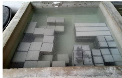
(d) Water curing
