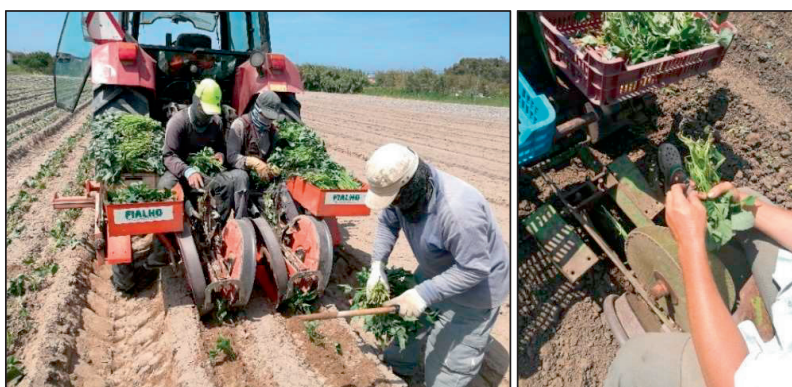
Figura 9. Plantación mecánica de batata en Portugal (izquierda) y en Hungría (derecha)
