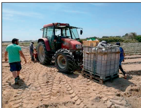
Figura 10. Tanque IBC montado en la parte delantera para riego al mismo tiempo que la plantación (Portugal)
