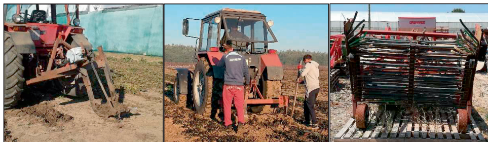
Figura 18. Recolección de batata con un recolector de hileras de horquillas y un cortador de plántulas, así como con una cosechadora de papas modificada (de izquierda a derecha)
