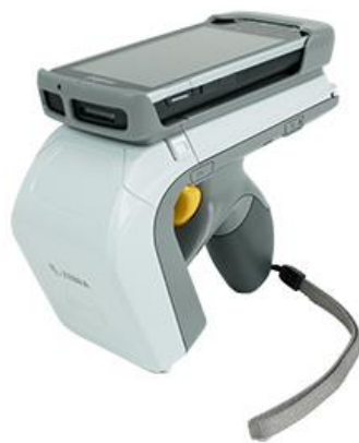
Figura 39. Escáner de manual RFD8500I de ZEBRA
