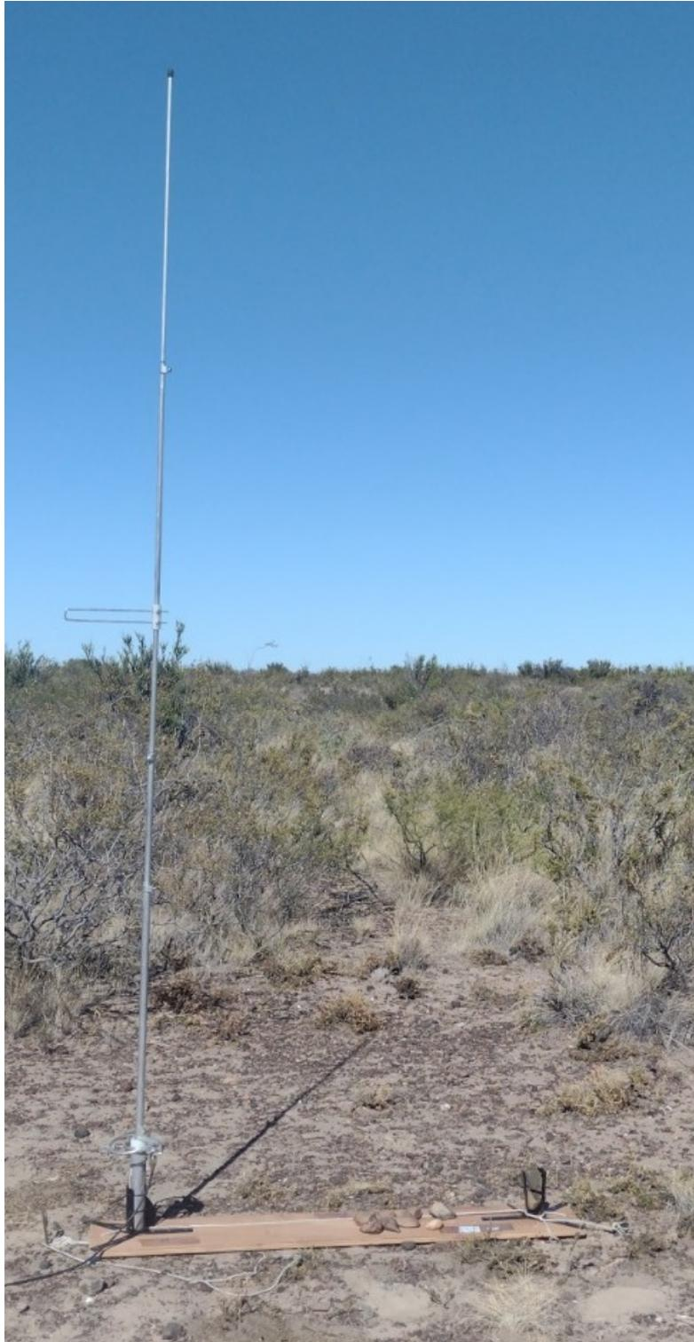
**Figura 5.7:** Estación receptora colocada en campo con antena monopolo de 2 metros de altura.
