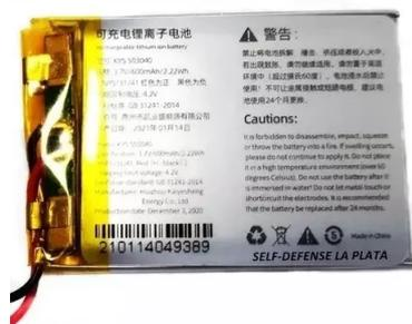
Figura 3.2: Batería tipo LiPo de 3.7 V y 600 mAh.
