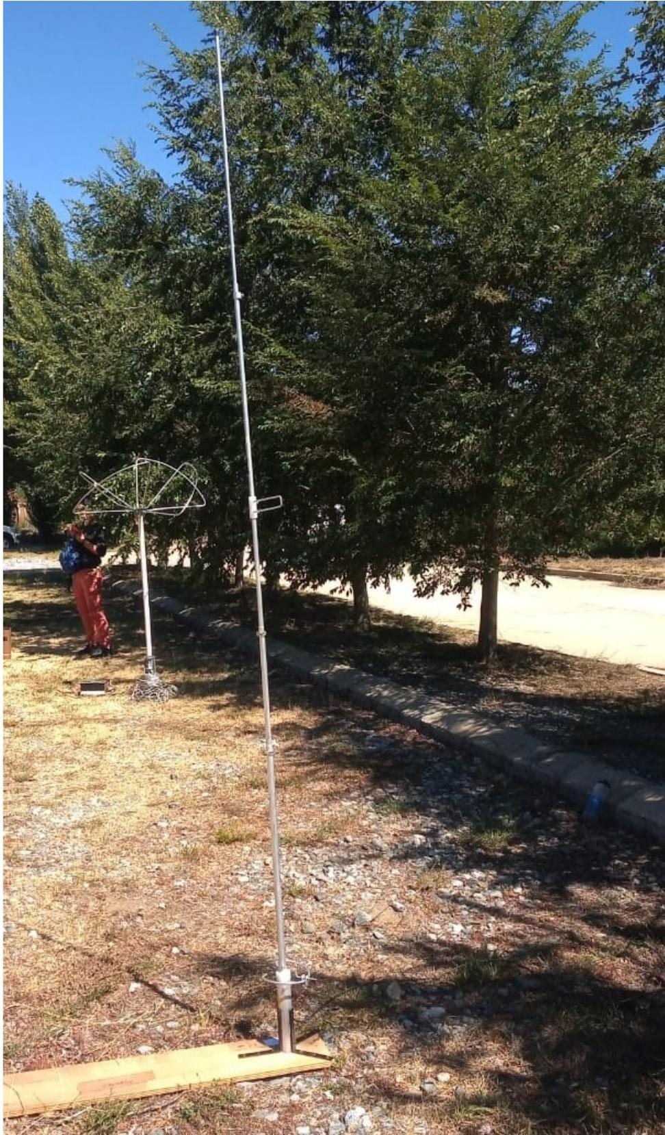
**Figura 5.6:** Imagen de antena tipo monopolo dentro del campus del Instituto Balseiro.
