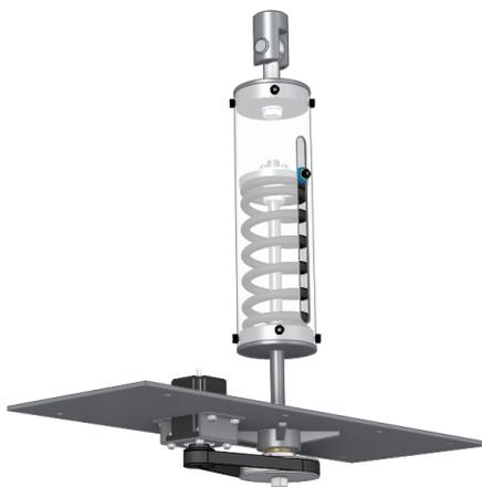
**Figura 7.2:** Esquema del diseño final del sistema de carga.
