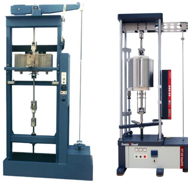
**Figura 2.1:** Imágenes de máquinas de ensayos comerciales ofrecidas por ATS y Zwick Roell. [6], [7]
