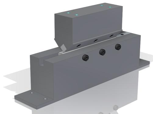
**Figura 7.4:** Esquema del conjunto knife edge.
