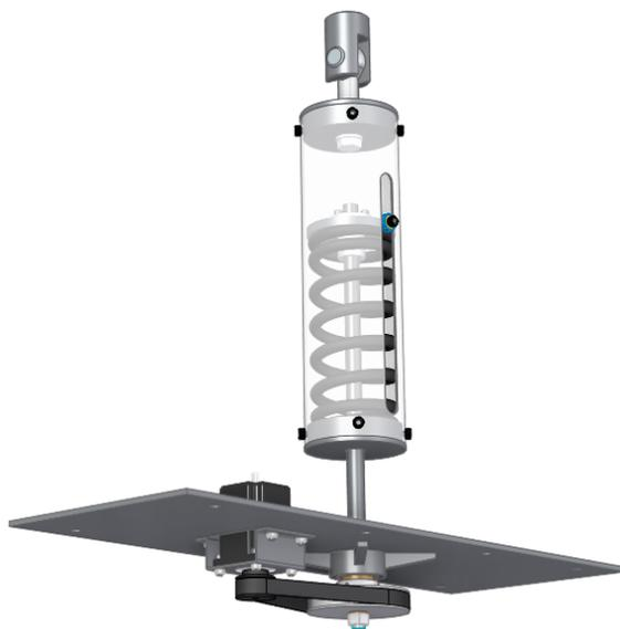
**Figura 4.12:** Esquema del diseño final del sistema de carga. El recubrimiento del resorte se muestra transparente para mostrar los componentes interiores.
