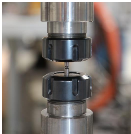
Abbildung 4-8: Prüfaufbau für Zeit- und Dauerfestigkeitsversuche am Nietwerkstoff
