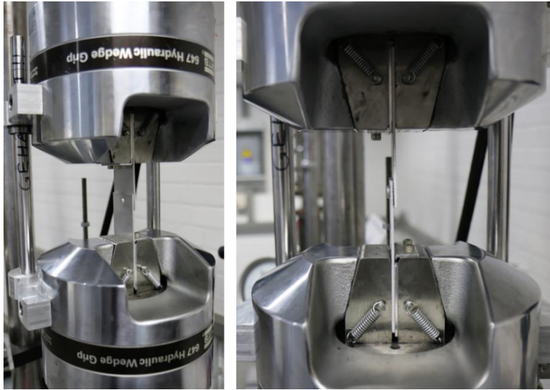
Abbildung 7-1: Einschnittig überlappte Scherzugprobe EÜP nach [DVS 3480]
