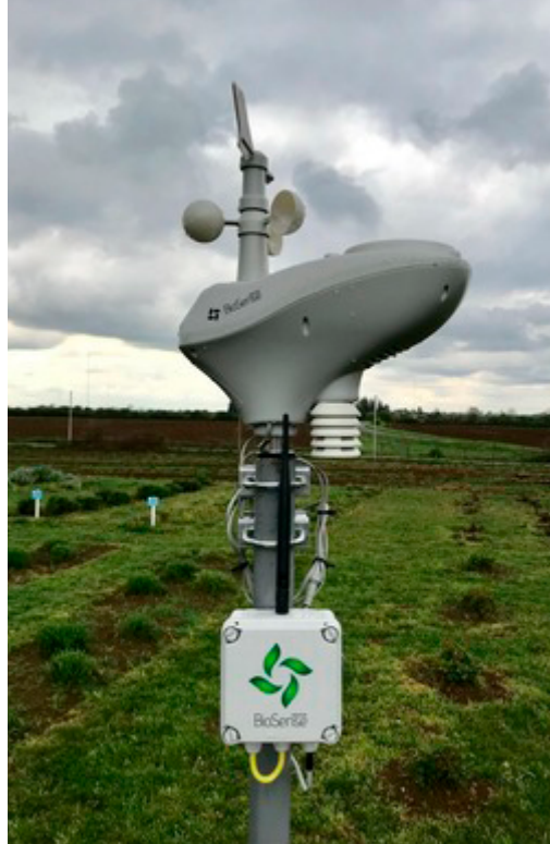
Figura 16. Estación meteorológica desarrollada para uso agrícola por PA4ALL (Fuente: BioSense Institute)
