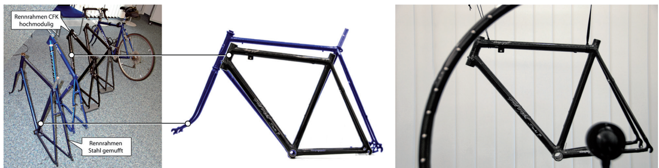
Abb. 2.3.o: Auswahl verschiedener Rahmentypen und geometrischer Vergleich der beiden untersuchten Rahmen. Rechts: frei schwingender CFK-Rahmen (Spezialanfertigung für Erik Zabel – Dank an „zfl – Zentrum für Faserverbunde und Leichtbau Haldensleben UG“; Jürgen Häberle; Julia Schulz für Entwicklung, Bau und Zurverfügungstellung) vor Array Ring 48-75 AC Pro
