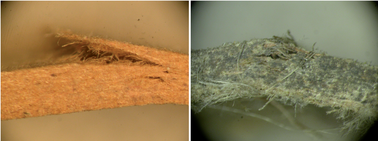
Abb. 1.5.1.e: Bruchbilder Naturfaser-Kunststoffverbunde; 80facher Zoom; links: MDF; rechts: Hanf
