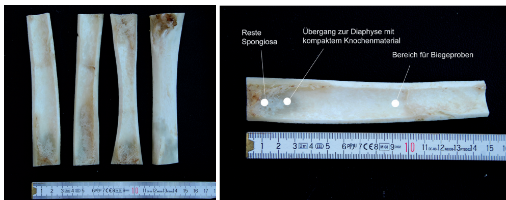
Abb. 1.4.4.b links: analog aufgetrennter Oberschenkelknochen mit gleichem strukturellem Aufbau vom 10-12 Monate alten Hausschwein; rechts: Knochenstruktur im Detail zur Festlegung der Probenentnahme für die Biegeversuche
