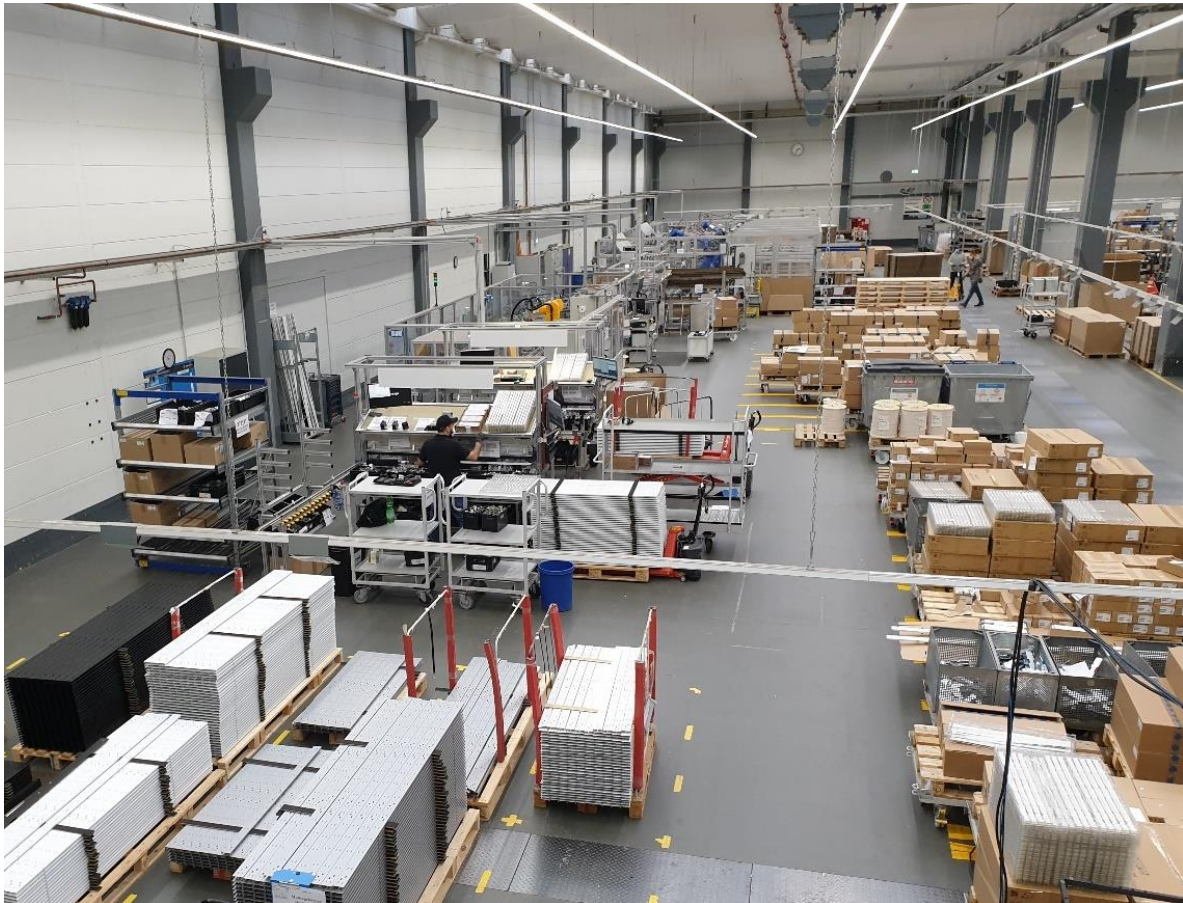
Abb. 1: Foto der Montagehalle (Länge: 80 m, Breite: 72 m, Lichtpunkthöhe: 7,3 m)
