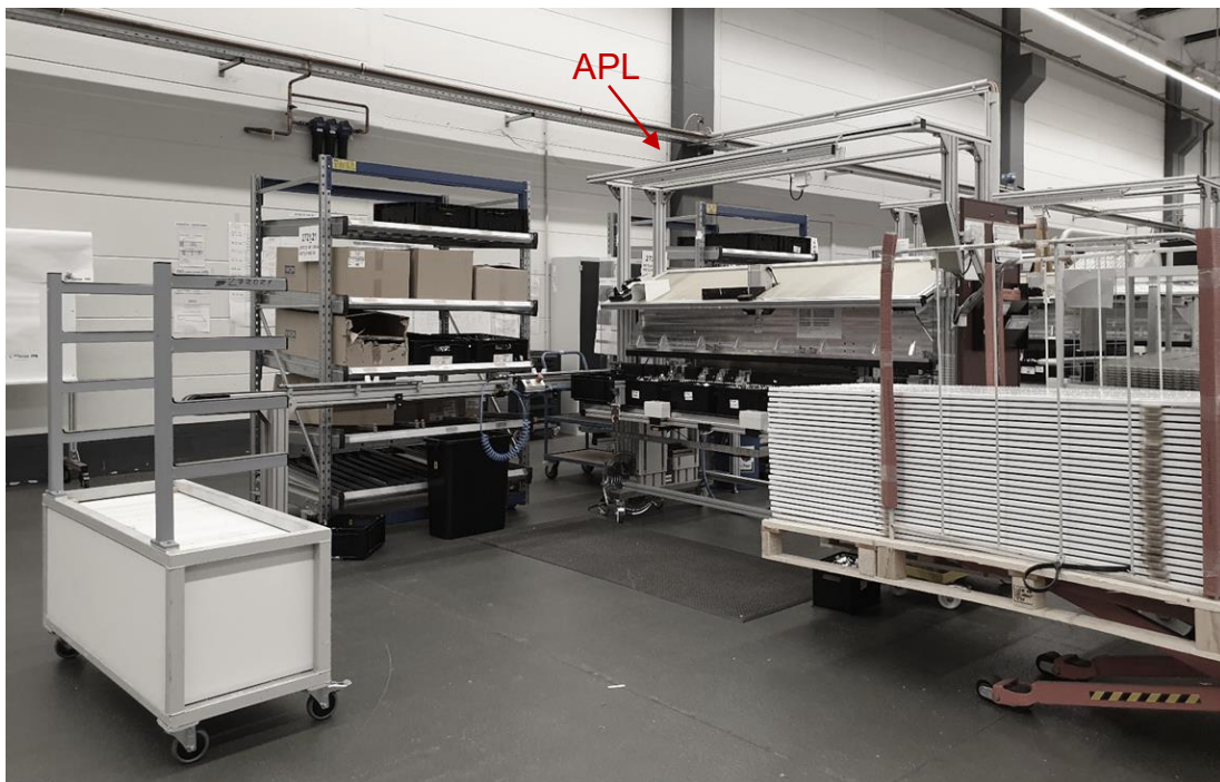
Abb. 2: Typischer Montagearbeitsplatz mit arbeitsplatzbezogener Beleuchtung (APL)
