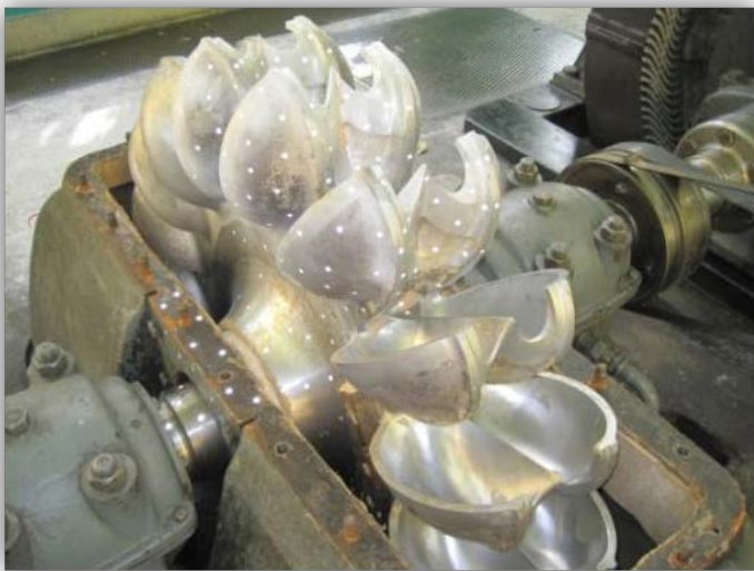
Slika 3. Radno kolo iz 1978. godine tip Pelton P1 0.9/120, Litostroj
