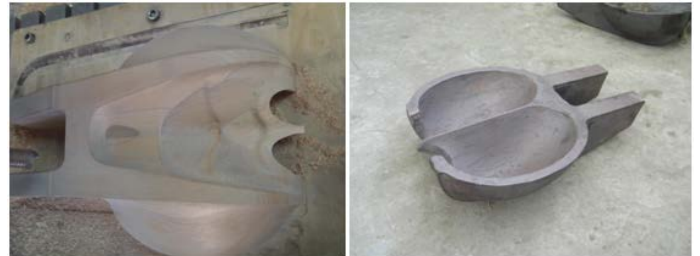
Slika 10. Drveni model i odlivena lopatica
