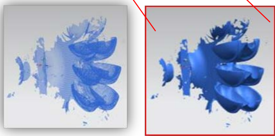
Slika 5. Proces digitalizacije radnog kola Peltonove turbine
