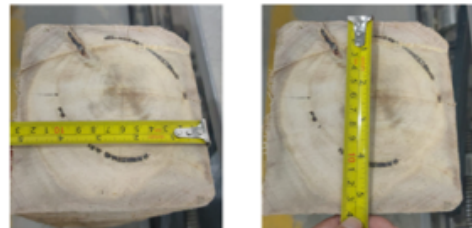
Fotografía 2: Secciones para análisis de propiedades físicas y mecánicas del eucalipto patrimonial y nuevo
