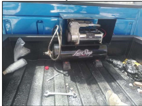
Figura 8 Colocación del compresor
