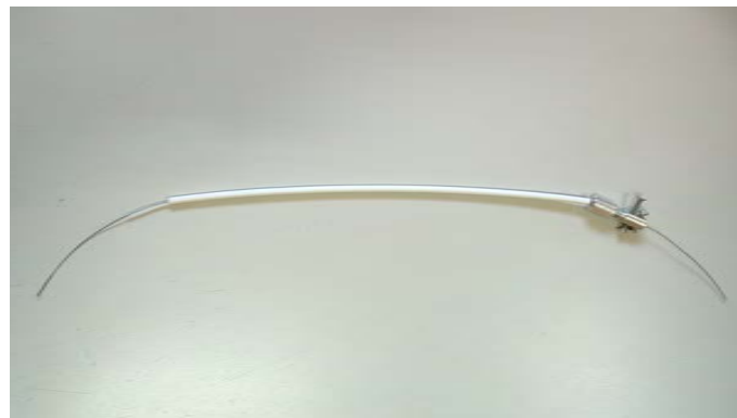
Figura 3.14: Montaje del actuador basado en SMA.
