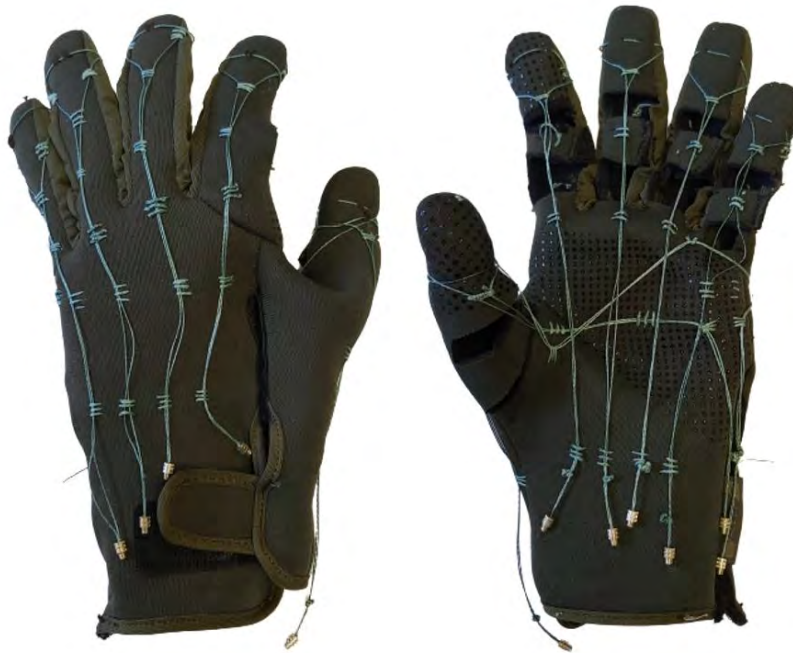
Figura 3.9: Diseño final del guante con tendones artificiales
