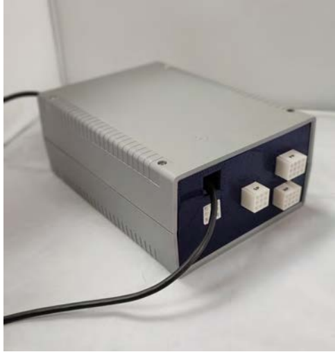
Figura 3.26: Caja que alberga toda la electrónica del exo-guante.
