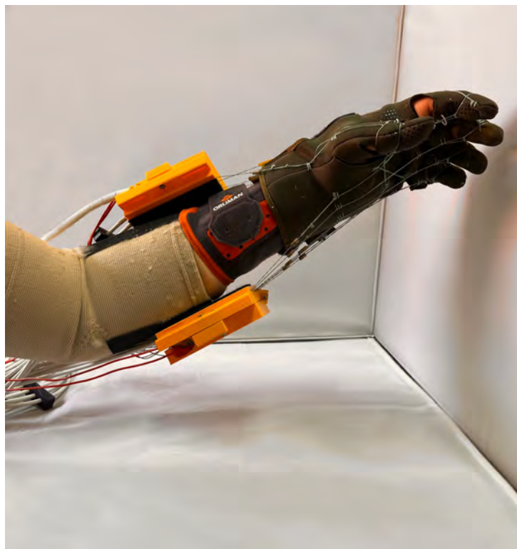
Figura 3.28: Exo-guante para rehabilitación de la mano.
