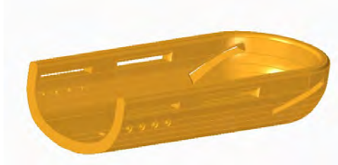
Figura 3.31: Soporte antebrazo del banco de pruebas.
