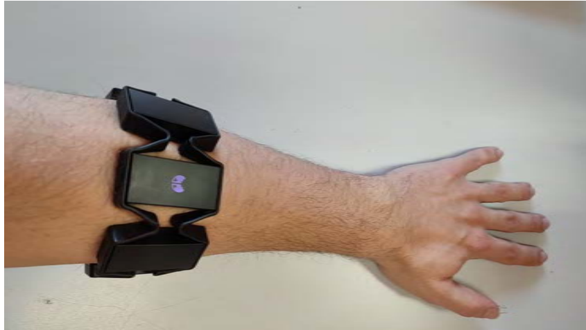
Figura 4.23: Colocación de MYO Armband en el antebrazo
