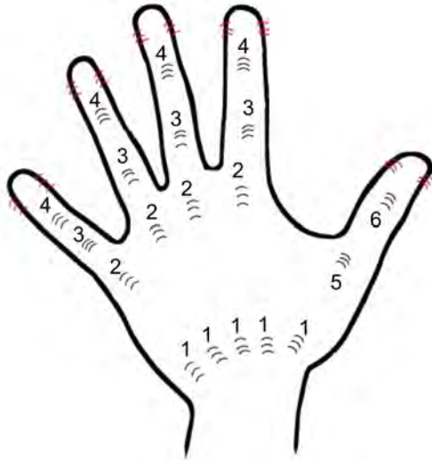
Figura 3.7: Puntos de sujeción y paso de los tendones artificiales en el dorso de la mano
