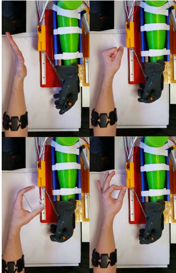
Figura 4.25: Prueba del clasificador con algunos movimientos.
