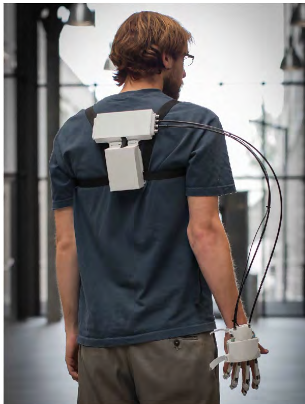
Figura 2.12: Exoesqueleto con la actuación colocada sobre la espalda del usuario. [37]
