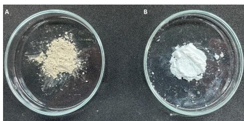
Figura 2. Zeolita A. Derecha: [Ag^+]=21\% . Izquierda: [Ag^+]= 11,4 y [Zn^{2+}]= 7,4 .
