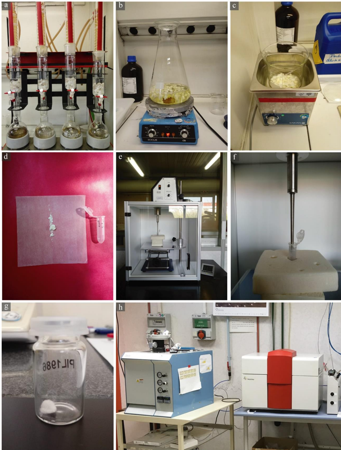
Figura 3.3. Extracción de la \alpha -celulosa de la madera de acuerdo con el método químico SOXHLET. a) Muestras en el equipo SOXHLET para la eliminación de grasas y resinas. b) Proceso de extracción de lignina. c) Baño ultrasónico. d) Muestras luego de la extracción de la \alpha -celulosa. e y f) homogeneización de la \alpha -celulosa a través de un sonotrode. g) \alpha -celulosa homogeneizada y liofilizada. f) analizador elemental acoplado con el espectrómetro de masa.
