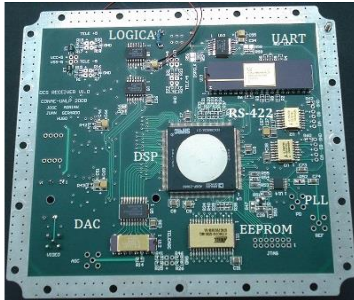
Fig.3. Modelo de ingeniería placa DSP vista inferior
