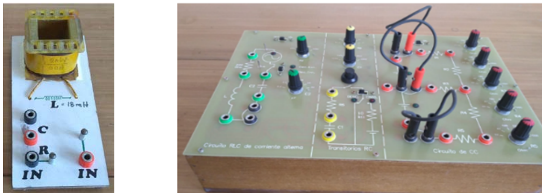
Imagen 5. a. Placa primigenia utilizada en laboratorios de corriente alterna. b. Placa Autónoma PALC - 1.
