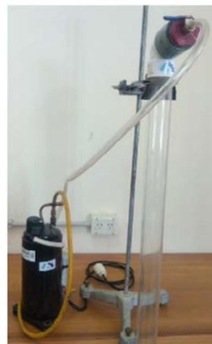
Imagen 3. a. Dispositivo de independencia del movimiento. b. Tubo de Newton con bomba de vacío.
