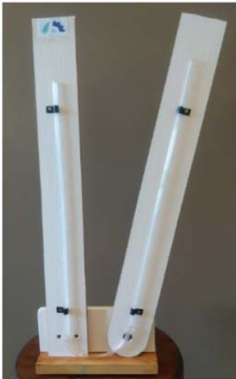
Imagen 2. a. Medidor de presión, tubo en U. b. Medidor de presión de brazo inclinable.
