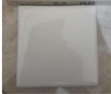
Gambar 6. Keramik dari silika lumpur lapindo yang sudah diekstraksi
