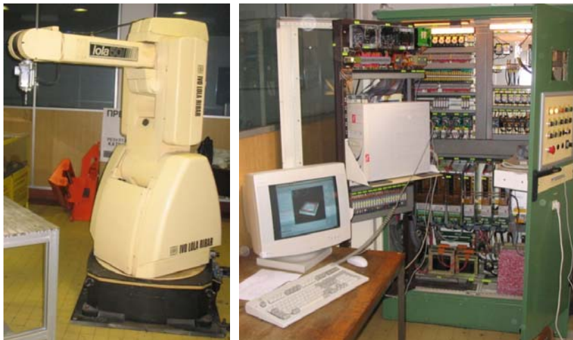
Slika 4. Elementarna obradna ćelija na bazi robota Lola 50 sa realizovanim upravljačkim sistemom primenom softvera EMC2
