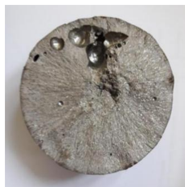
Slika 6. Izgled odlivka - flotacione kugle nakon ispitivanja na udar
