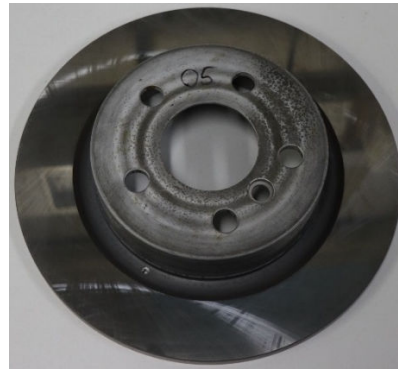
Fig. 3. Hartmetallbeschichtete Bremsscheibe des BMW i3 (nach Einsatz)
