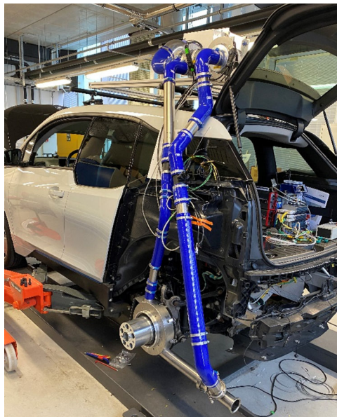
Fig. 8. Einhausung und Belüftungssystem der Bremse am Referenztestfahrzeug
