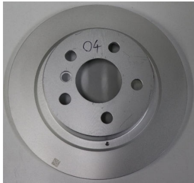
Fig. 2. Original Graugussbremsscheibe des BMW i3 (Neu-Zustand)
