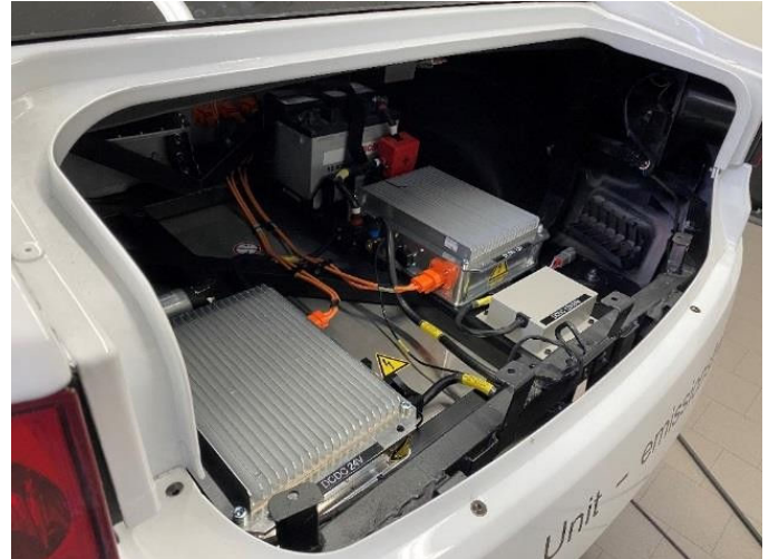
Abbildung 212: DC/DC-Wandler und LV-Batterie
