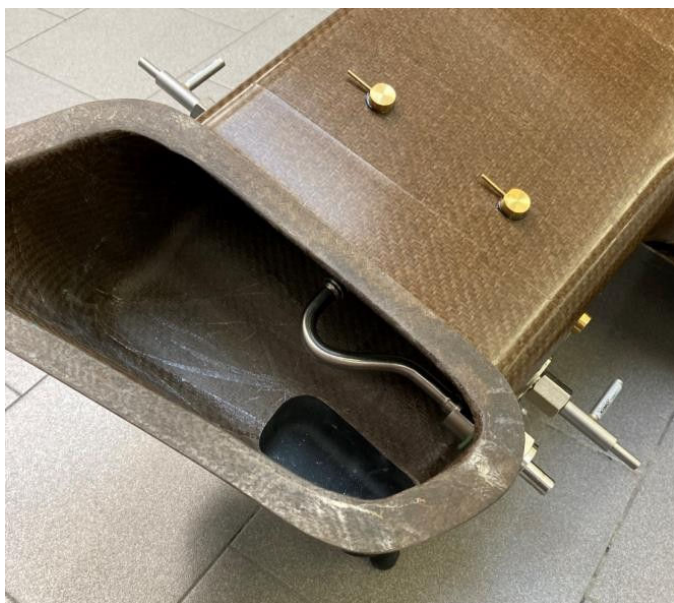
Abbildung 210: Messstellen im Filter- / Lüftergehäuse
