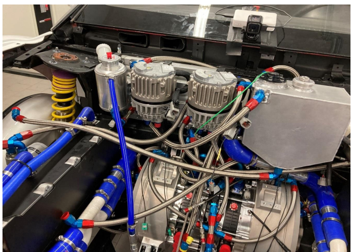
Abbildung 196: Ölpumpen und Ausgleichbehälter Dielektrikum
