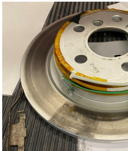
Abbildung 253: Thermoelementintegration Bremsscheibe für Telemetriemodul
