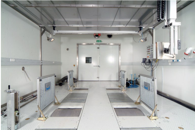
Abbildung 233: Rollenklimaprüfstand am DLR-FK Stuttgart
