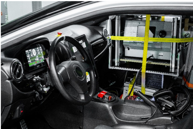
Abbildung 270: ZEDU1-Versuchsträger. Packaging der Messtechnik für Versuchsfahrten
