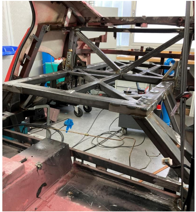
Abbildung 186: Fahrzeugheck & Batterierahmen. Rohbauanpassung für Batterieintegration.
