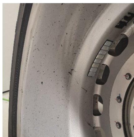
Abbildung 277: Partikel in der Messkammer nach Messfahrten hinter der Umhausung (links) und in der Felge (rechts)
