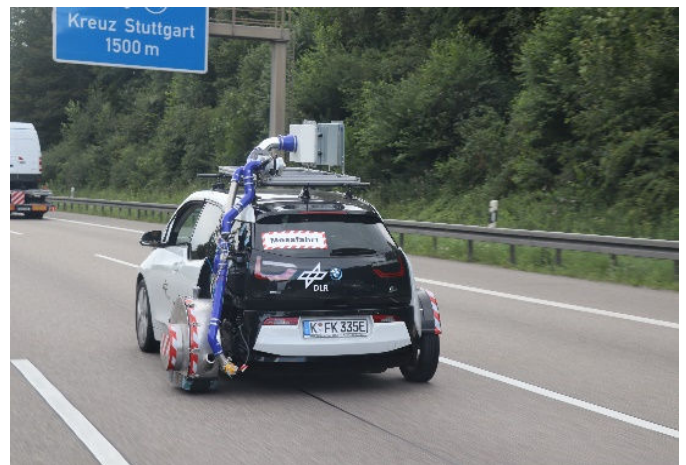
Abbildung 231: RDE-Fahrt. Testfahrzeug BMW i3
