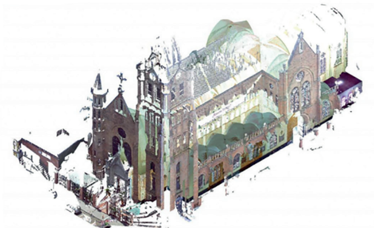
Figura 6. Imágenes obtenidas con escáner láser terrestre para trabajos de grado de Arquitectura. Fuente: herramientas fotogramétricas y escáner láser terrestre en la obtención de planimetría y propuesta de intervención urbana. Iglesia Sagrado Corazón de Jesús, Medellín, 2017. María Alejandra Escobar O.
