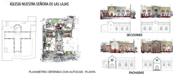
Figura 2. Planimetría obtenida con escáner láser terrestre en trabajos de grado de Arquitectura. Fuente: aplicación de herramientas fotogramétricas y escáner láser terrestre en la estructuración de datos arquitectónicos de la iglesia Nuestra Señora de Las Lajas, Medellín, 2015. María Isabel Zapata Moreno.
