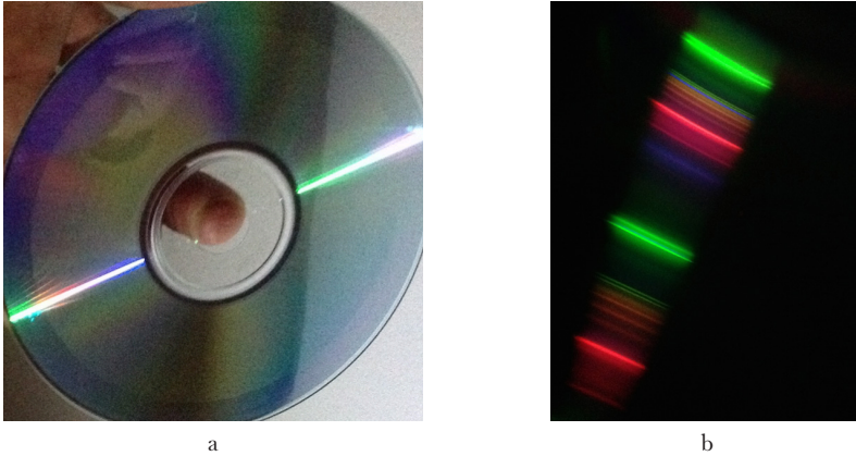
Figura 2.13. Un CD (a) se puede utilizar como rejilla de difracción para construir un espectroscopio casero que permite tomar espectros como el de un bombillo fluorescente ahorrador de energía, (b) obsérvese que el espectro de la lámpara fluorescente es discontinuo
