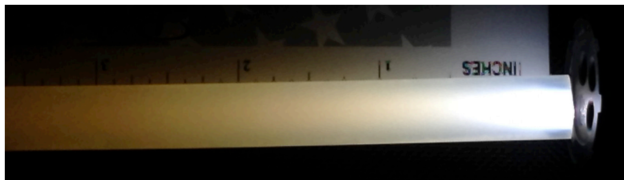
Figura 5.18. Dispersión de la luz blanca de una linterna en una barra de silicona. Obsérvese cómo los colores rojo y amarillo penetran mucho más la barra mientras que la luz azul es dispersada más efectivamente en la zona de la barra más cercana a la linterna
