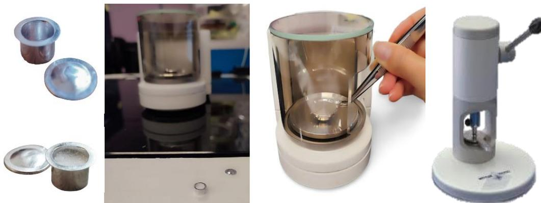
*Figura 13. Preparación de la muestra en los crisoles*
