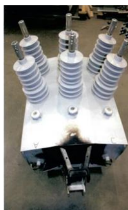
Figura 15. Reconectador automático OMS en pruebas de arco interno eléctrico_V2
