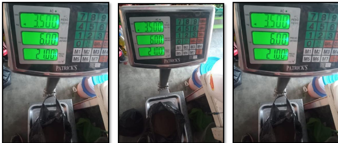
Figura 12. Pesado de tierra agrícola para el tratamiento N° 01 según la dosificación (100% de tierra agrícola y 0% de biochar)
