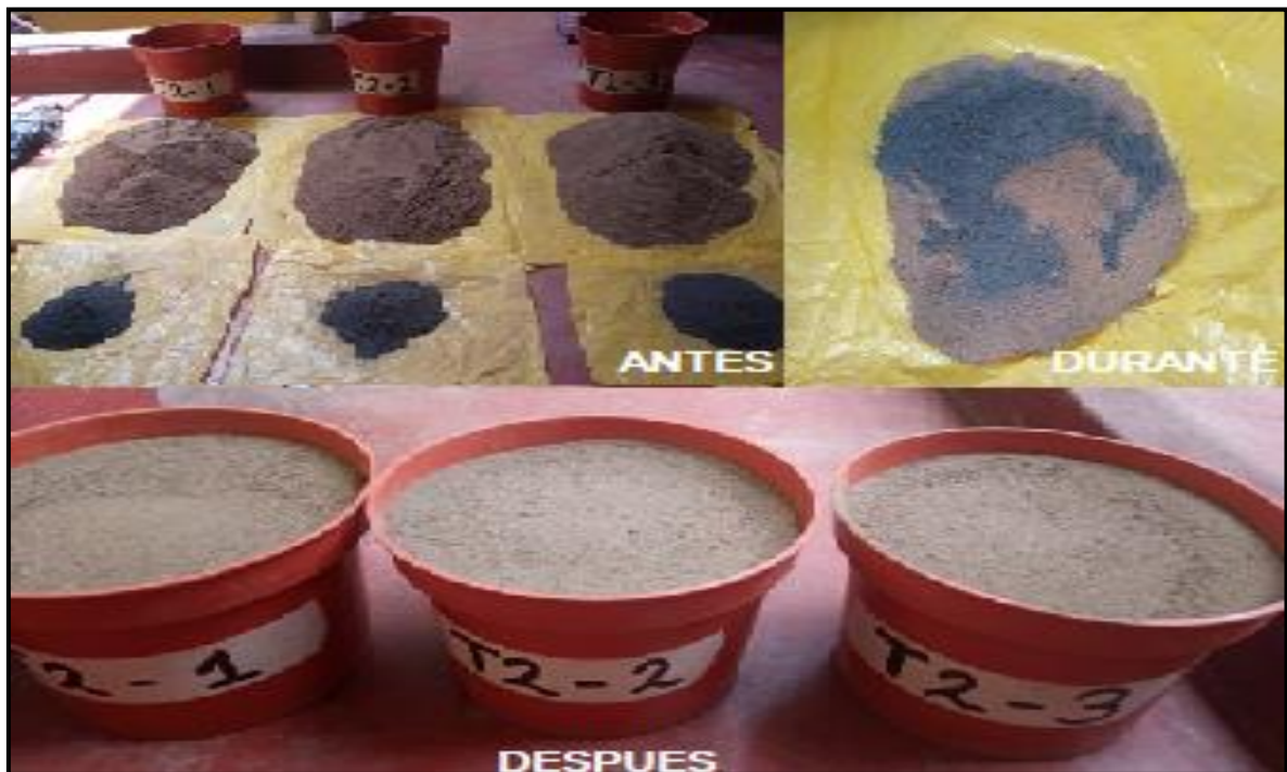
Figura 14. Pesado de tierra agrícola y biochar para el tratamiento N° 02 según la dosificación (98% de tierra agrícola y 2% de biochar)
