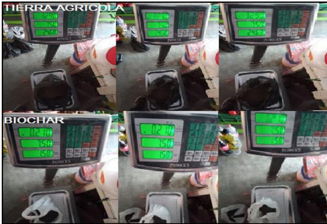
Figura 18. Pesado de tierra agrícola y biochar para el tratamiento N° 04 según la dosificación (94% de tierra agrícola y 6% de biochar)
