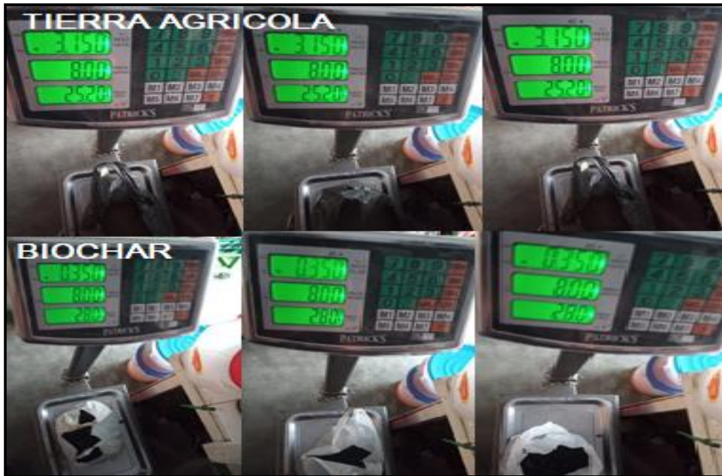
Figura 22. Pesado de tierra agrícola y biochar para el tratamiento N° 06 según la dosificación (90% de tierra agrícola y 10% de biochar)
