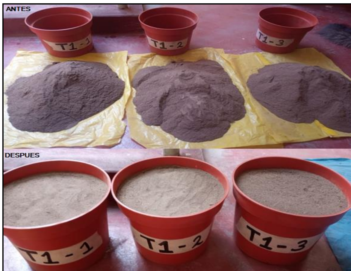
Figura 12. Pesado de tierra agrícola para el tratamiento N° 01 según la dosificación (100% de tierra agrícola y 0% de biochar)
