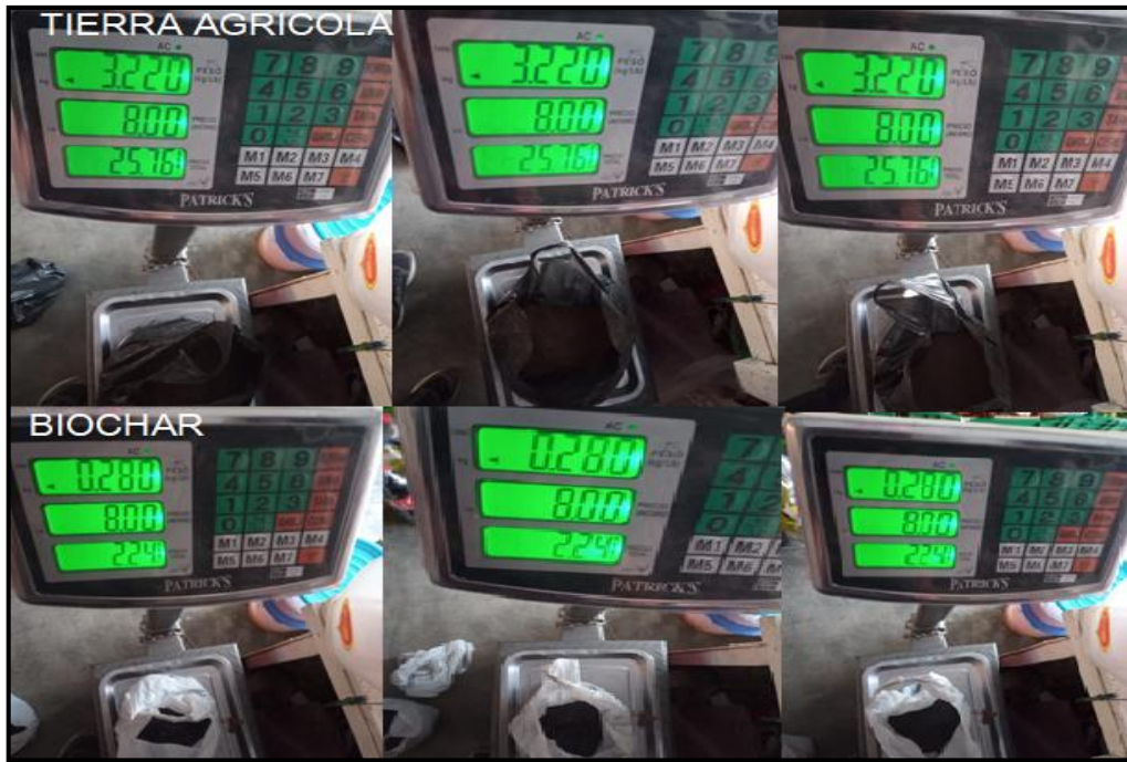
Figura 20. Pesado de tierra agrícola y biochar para el tratamiento N° 05 según la dosificación (92% de tierra agrícola y 8% de biochar)
