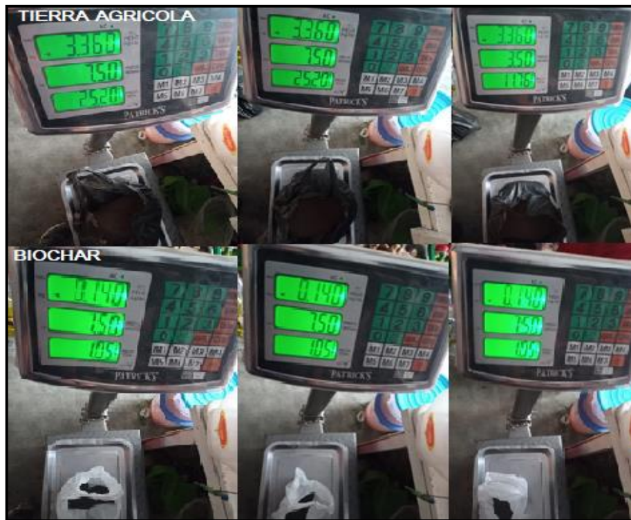
Figura 16. Pesado de tierra agrícola y biochar para el tratamiento N° 03 según la dosificación (96% de tierra agrícola y 4% de biochar)
