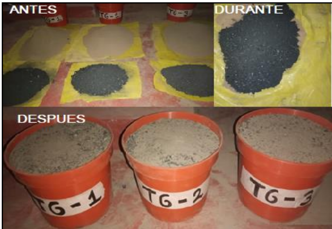
Figura 22. Pesado de tierra agrícola y biochar para el tratamiento N° 06 según la dosificación (90% de tierra agrícola y 10% de biochar)
