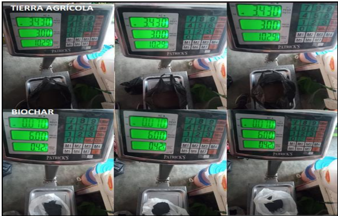
Figura 14. Pesado de tierra agrícola y biochar para el tratamiento N° 02 según la dosificación (98% de tierra agrícola y 2% de biochar)
