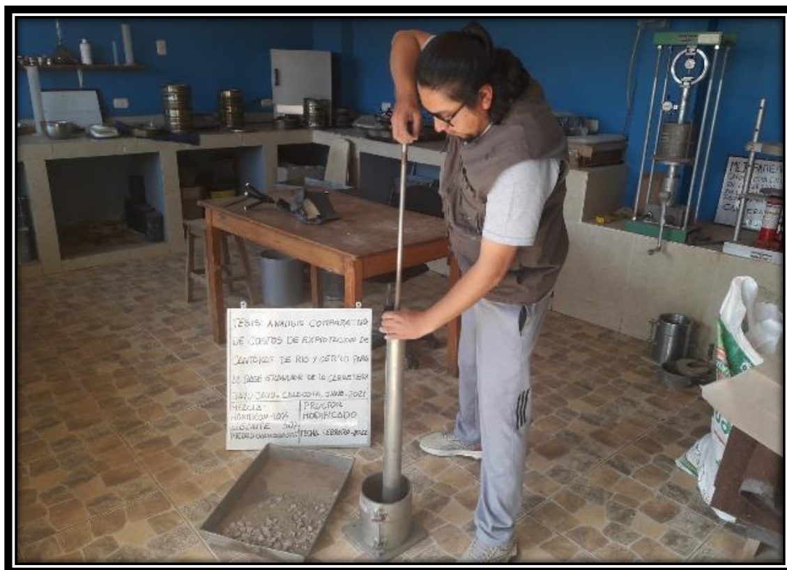
Fotografía 26: Pesado del Ensayo de Proctor Modificado con Muestra Compactada.
