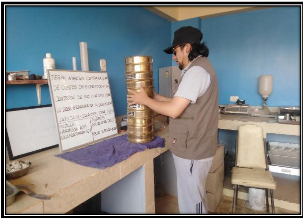
Fotografía 11: Ensayo de laboratorio para determinar la granulometría por tamizado.
