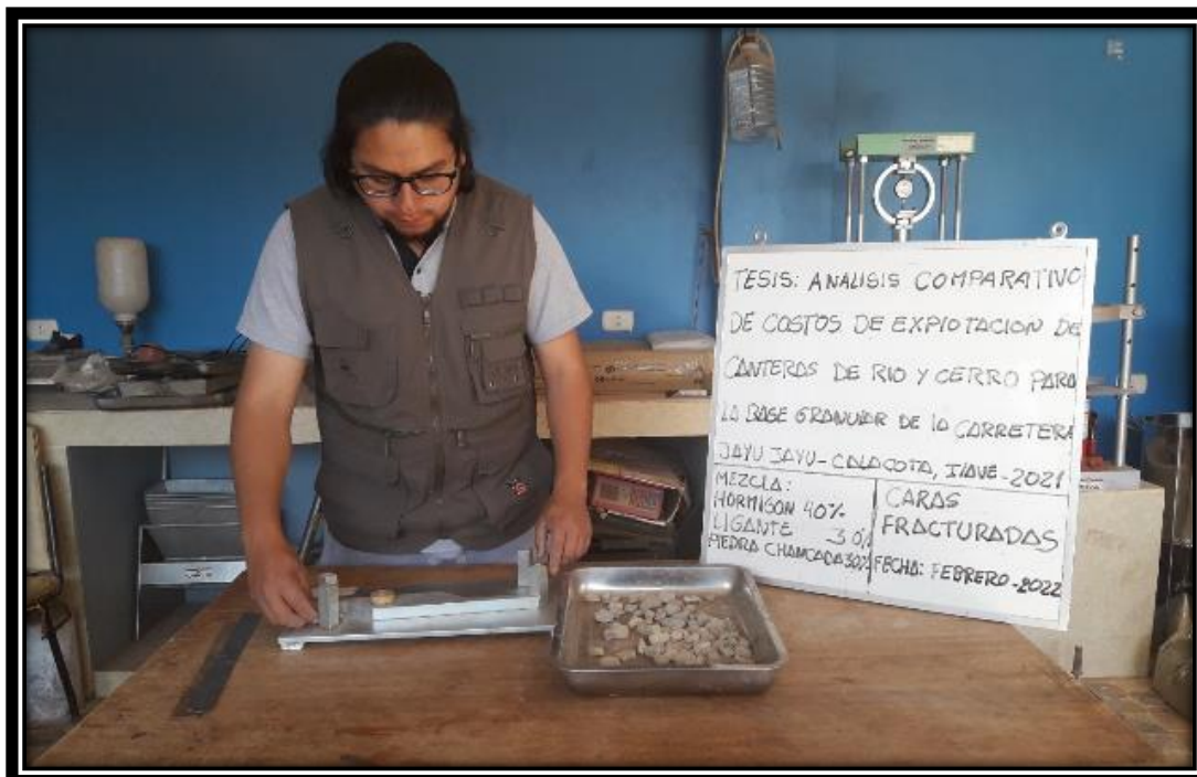
Fotografía 29: Ensayo de Caras Fracturas, Una Cara y Dos Caras, para la Propuesta N°01.
