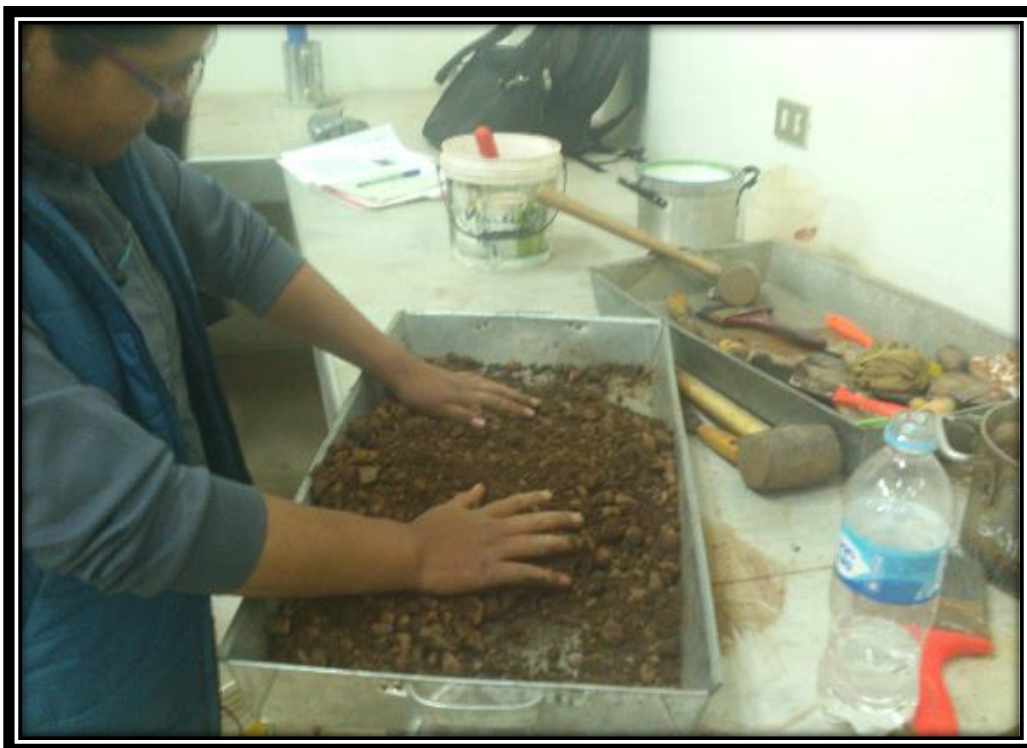
Fotografía 23: Cuarteo de Muestra para realizar el Ensayo de Proctor Modificado.
