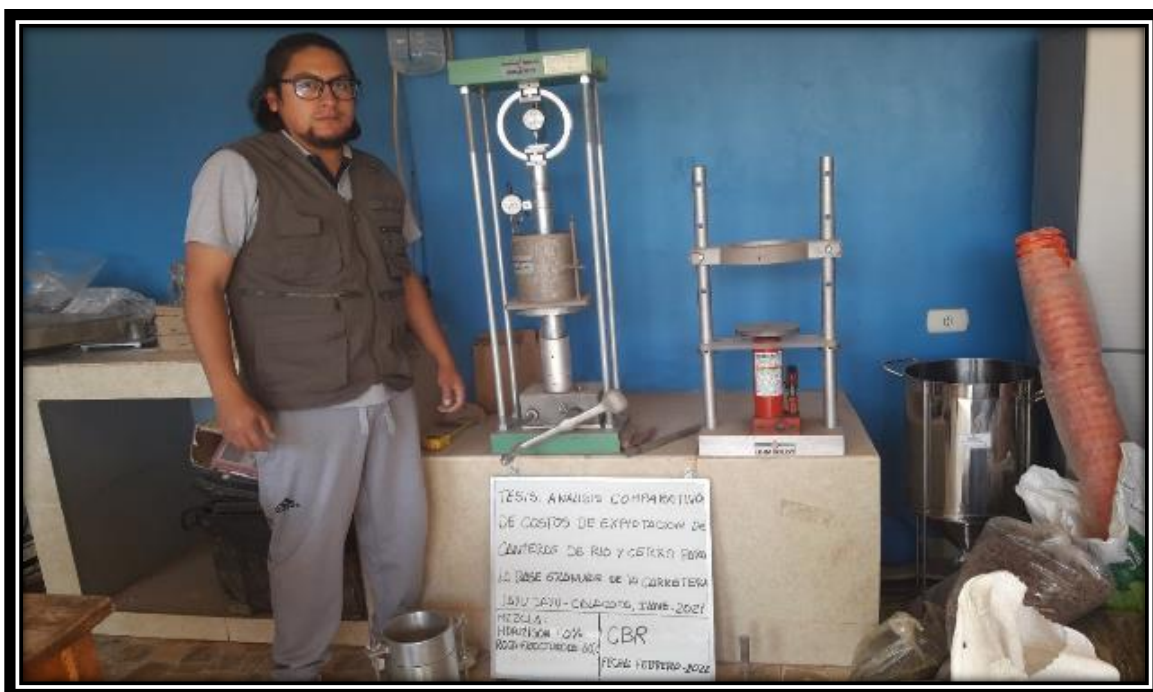
Fotografía 27: Aplicación de la carga sobre el pistón de penetración mediante la prensa CBR, para la propuesta N°01.
