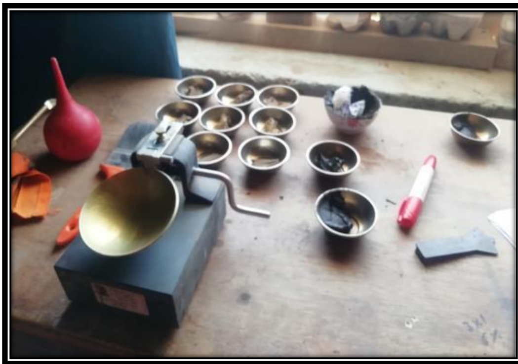
Fotografía 17: Equipo de laboratorio para determinar el límite líquido.
