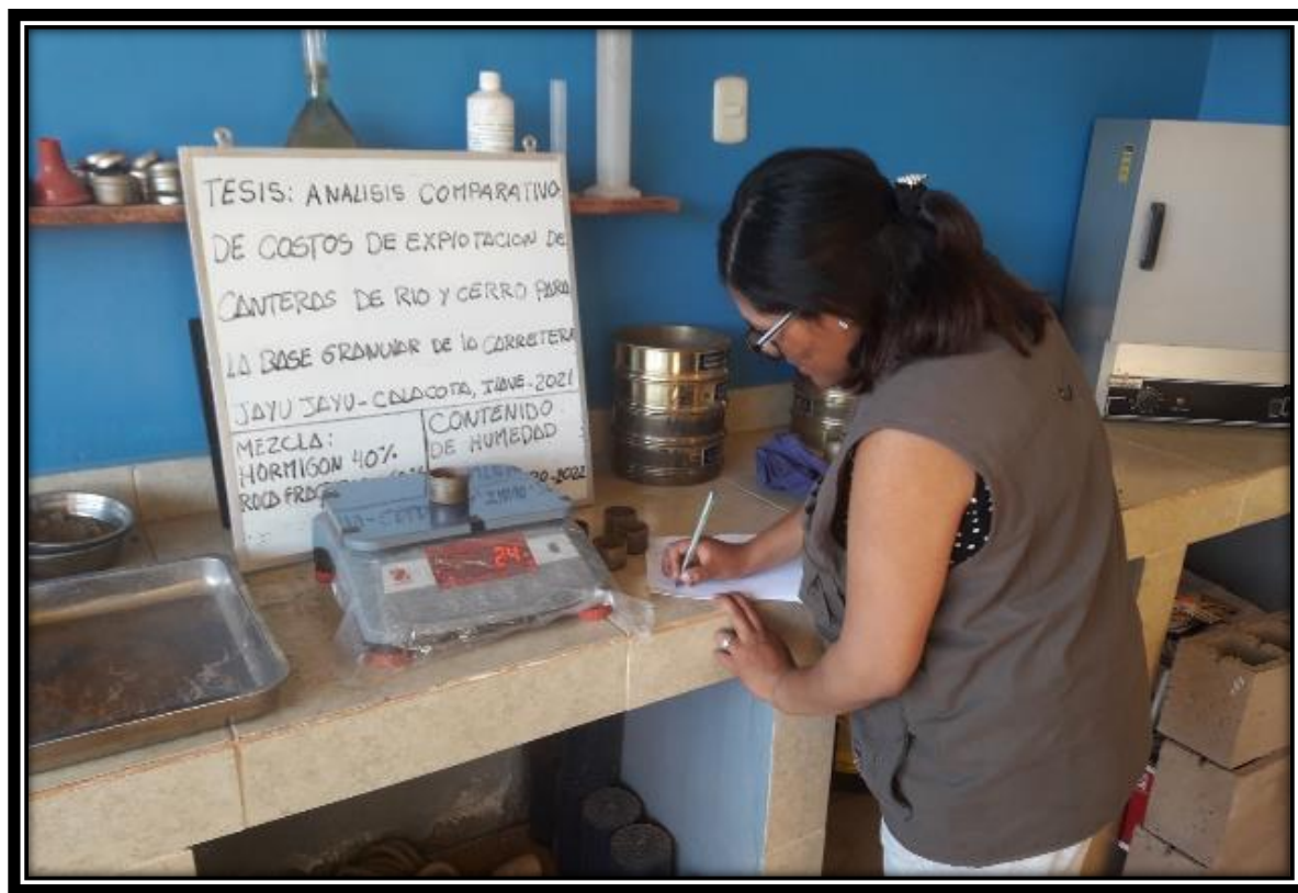
Fotografía 15: Pesado de Muestra después de sacar del Horno
