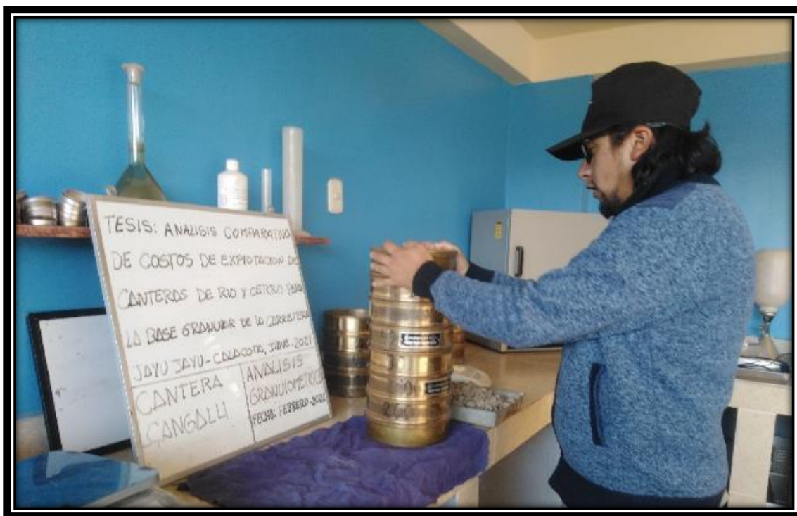
Fotografía 9: Tamizado de Material de la Cantera Cangalli.
