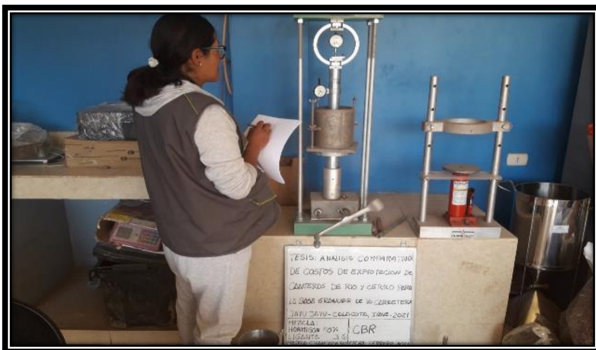
Fotografía 28: Aplicación de la carga sobre el pistón de penetración mediante la prensa CBR, para la propuesta N°01.
