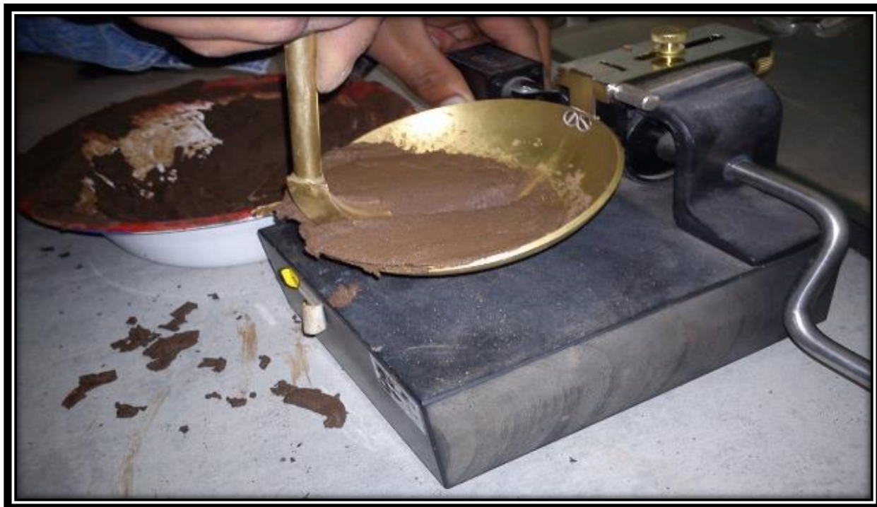
Fotografía 19: Ensayo de laboratorio para determinar el límite líquido.
