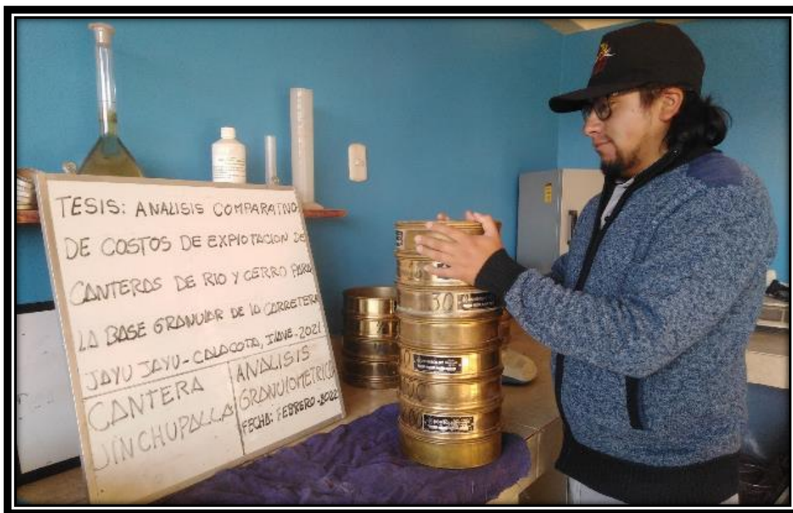
Fotografía 8: Tamizado de Material de la Cantera Jinchupalla.
