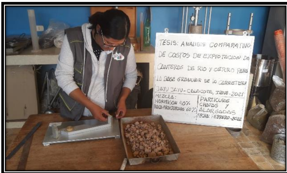
Fotografía 30: Ensayo de Partículas Chatas y Alargadas, para la Propuesta N°02.
