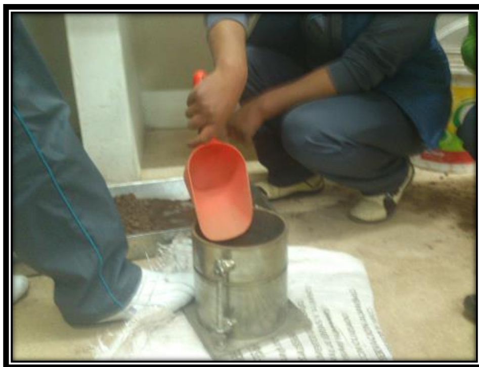
Fotografía 24: Llenado de Muestra para el Ensayo de Proctor Modificado.
