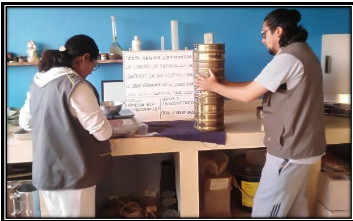
Fotografía 13: Ensayo de laboratorio para determinar la granulometría de la muestra.
