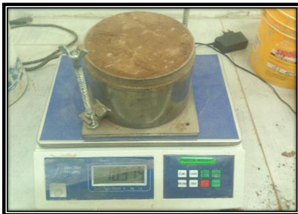
Fotografía 26: Pesado del Ensayo de Proctor Modificado con Muestra Compactada.
