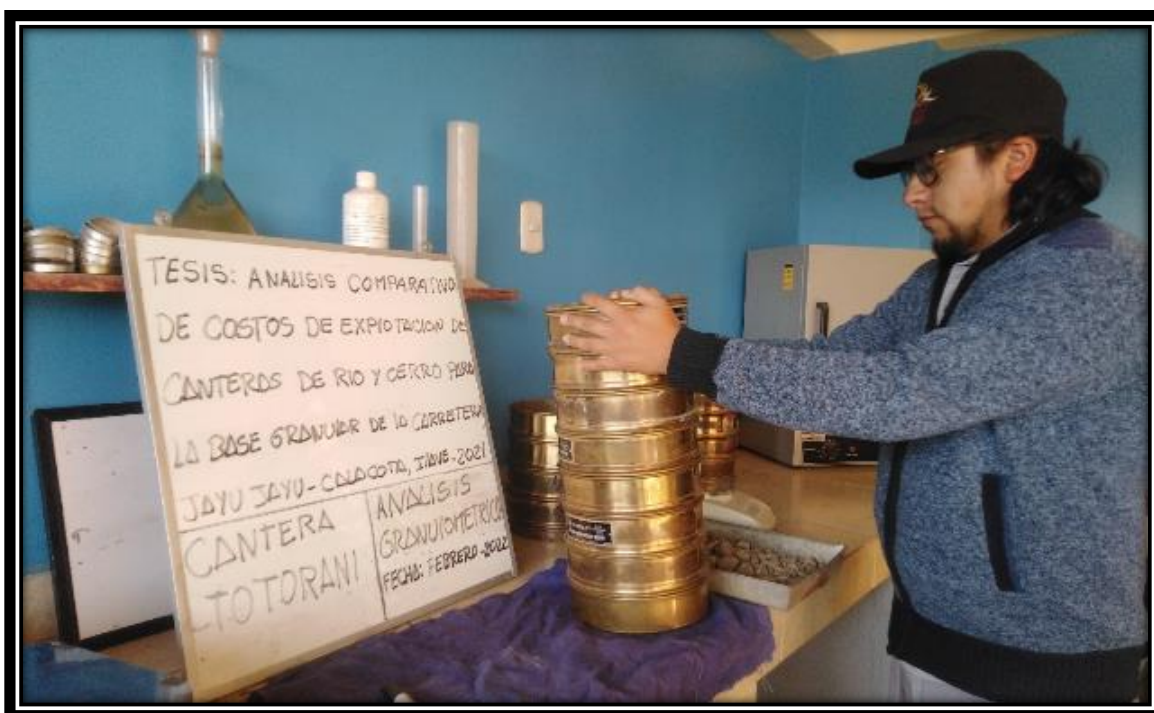
Fotografía 10: Tamizado de Material de la Cantera Totorani.
