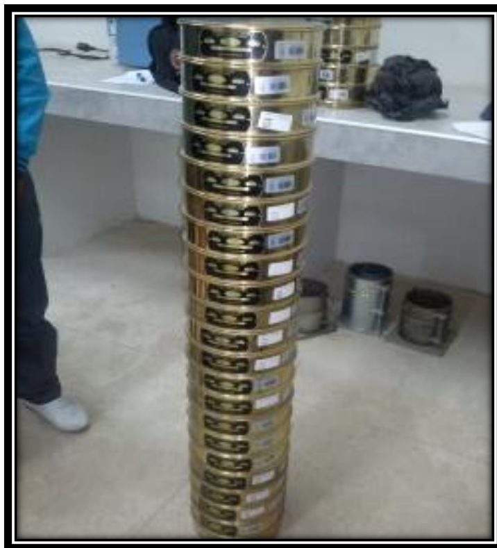
Fotografía 8: Tamizado de Material de la Cantera Jinchupalla.
