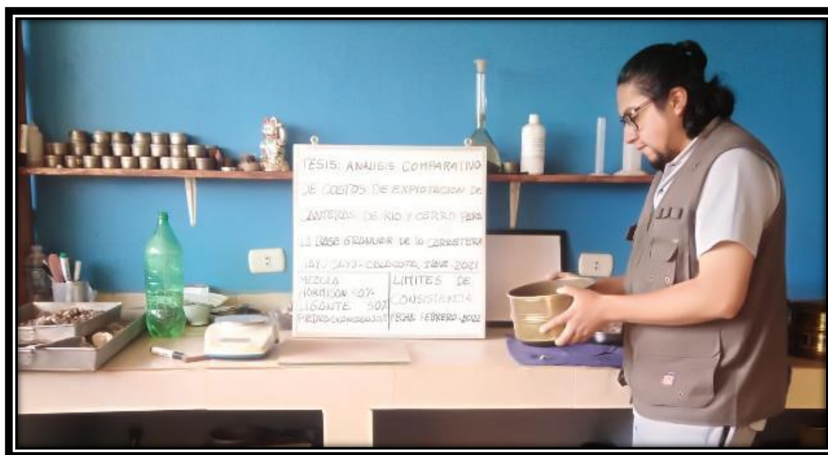
Fotografía 16: Tamizado de Muestra en la Malla N°40 para Ensayo de Limites de Consistencia.
