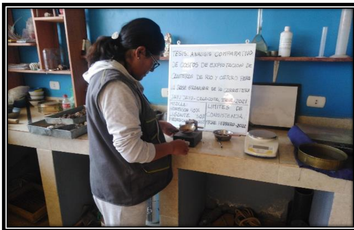
Fotografía 18: Ensayo de Límite Líquido en Equipo de Casa Grande.
