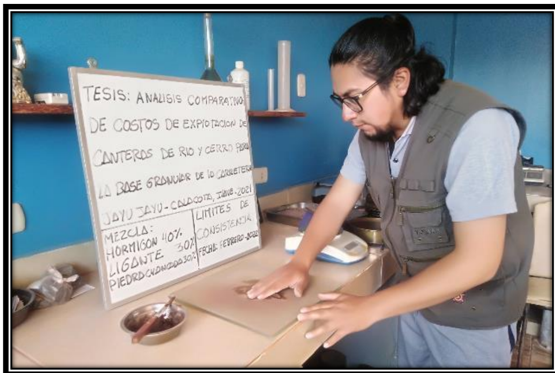
Fotografía 20: Ensayo de Laboratorio para determinar el Límite Plástico.
