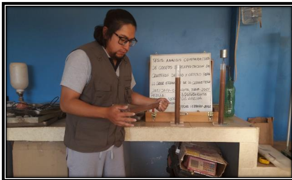
Fotografía 22: Ensayo de Laboratorio de Equivalente de Arena para la propuesta N°02.
