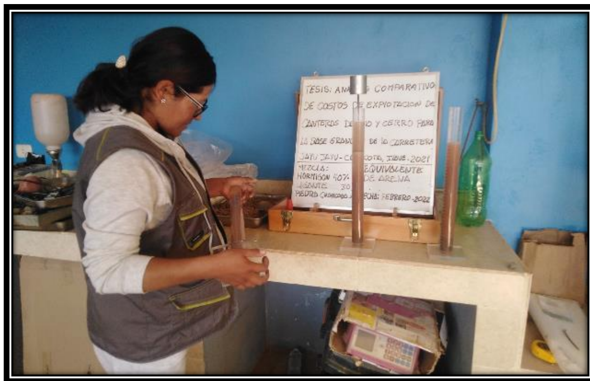
Fotografía 22: Ensayo de Laboratorio de Equivalente de Arena para la propuesta N°02.
