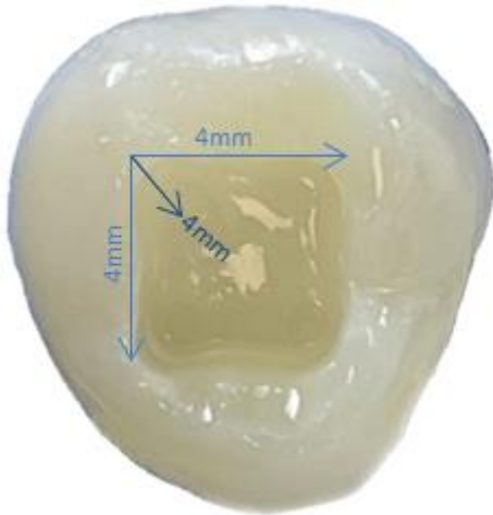
Abbildung 3: Schematische Darstellung der präparierten Kavität mit den Maßen 4mm x 4mm x 4mm
