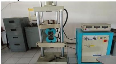
**Gambar 2.** Mesin uji tarik
