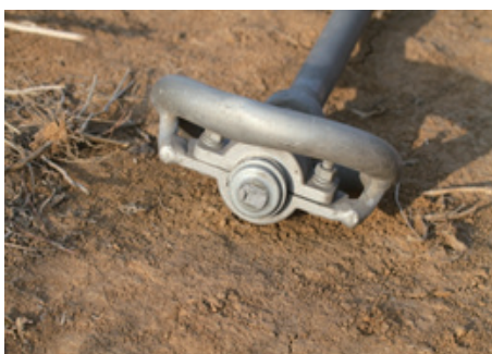
(c) 绝缘子串球头断裂
