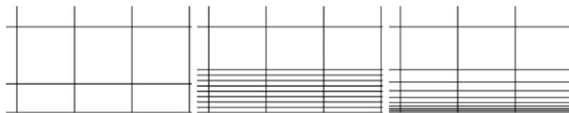
**Figura 3.8:** Resoluções da parede próximas em um canal de 1m de comprimento. A malha à esquerda representa  $y^+ = 200$ , a malha no meio  $y^+ = 40$  e a malha à direita  $y^+ = 10$ . Adaptado de Darvish (2015).
