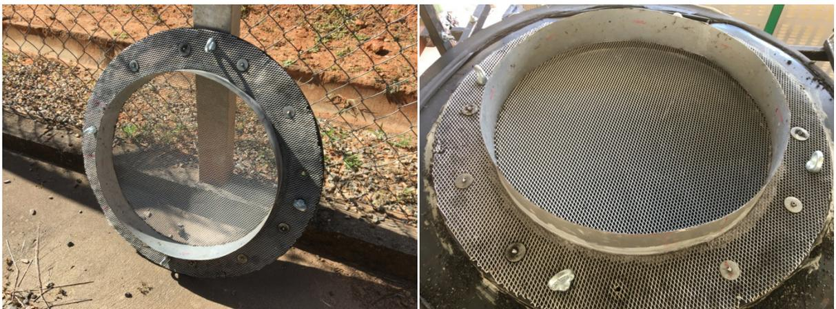
Figura 33: leito de secagem antes (esquerda) e após a instalação no secador (direita).
