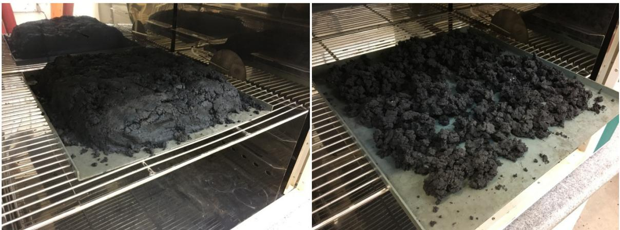
Figura 48: lodo centrifugado no início da secagem em estufa (esquerda) e ao final (direita).
