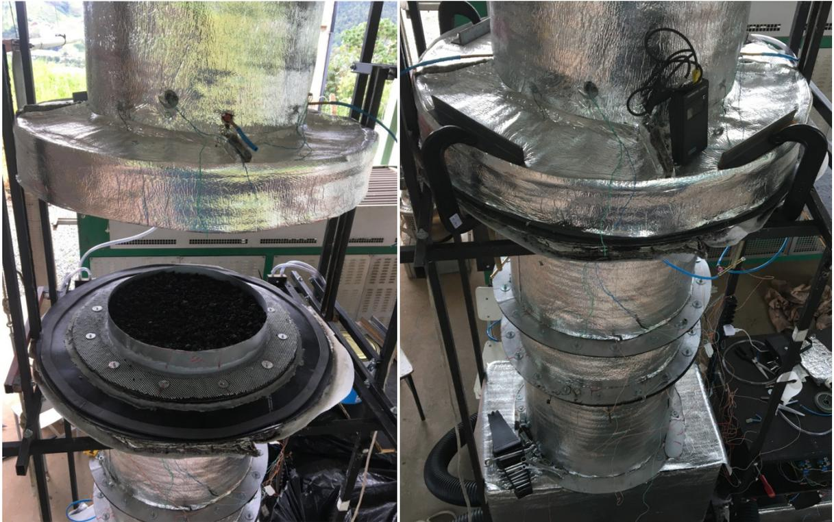
Figura 34: leito de secagem em carregamento (esquerda) e em operação (direita).
