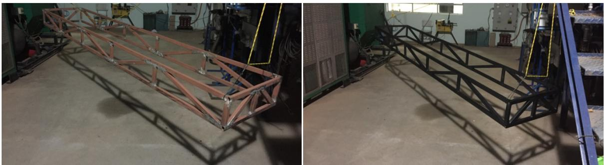
Figura 23: plataforma fabricada após a aplicação do zarcão (esquerda) e o acabamento (direita).
