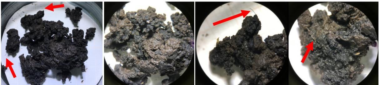
Figura 61: indicação, no lodo centrifugado, dos pontos com fios de cabelo.
