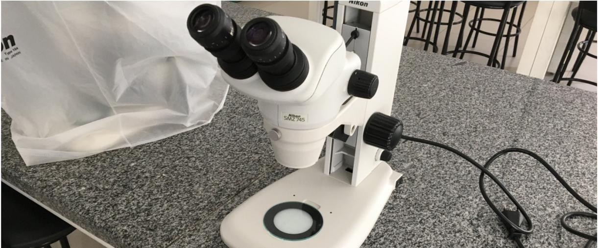
Figura 18: estereomicroscópio empregado na visualização dos grãos de lodo seco.
