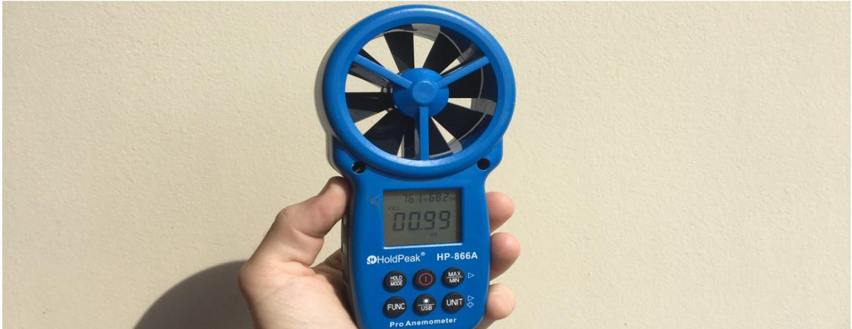
Figura 20: anemômetro utilizado na medição de vazão no ensaio de permeabilidade do lodo ao ar.
