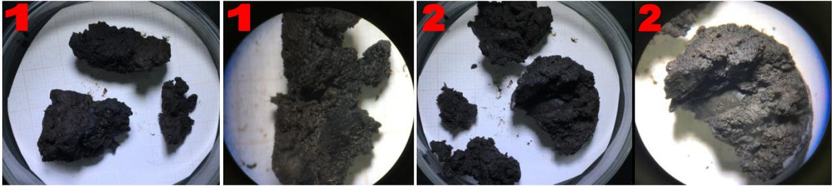
Figura 60: lodos úmidos com teores de 30% (1) e 20% (2) de ST com espessa camada de recobrimento.
