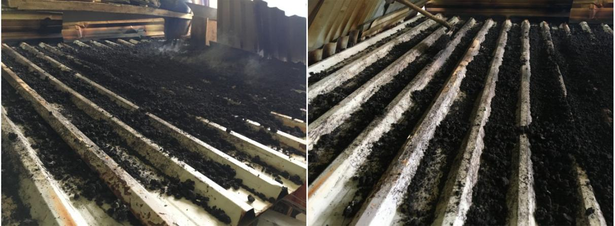
Figura 47: lodo após 7 dias de secagem com a granulometria grosseira e ausência de água livre.
