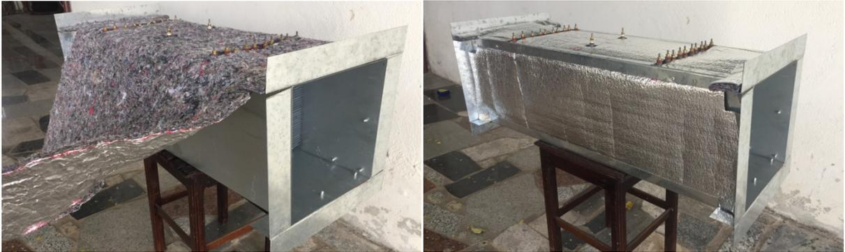
Figura 24: primeira (esquerda) e segunda (direita) camada do revestimento térmico.
