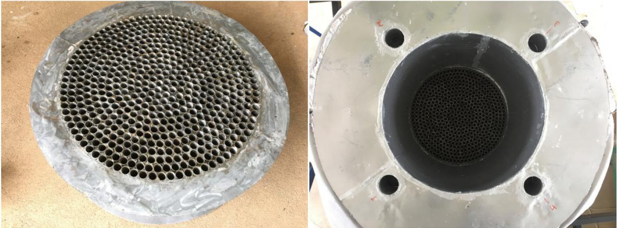
Figura 30: endireitador de fluxo antes da montagem (esquerda) e a vista superior do mesmo a partir do local que ficará o leito de secagem (direita).
