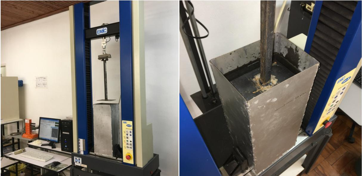
Figura 21: máquina universal de ensaio durante a análise das TAS.
