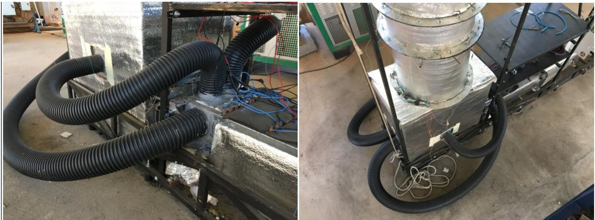
Figura 29: mangotes saindo do duto de aquecimento (esquerda) e entrando na caixa (direita).
