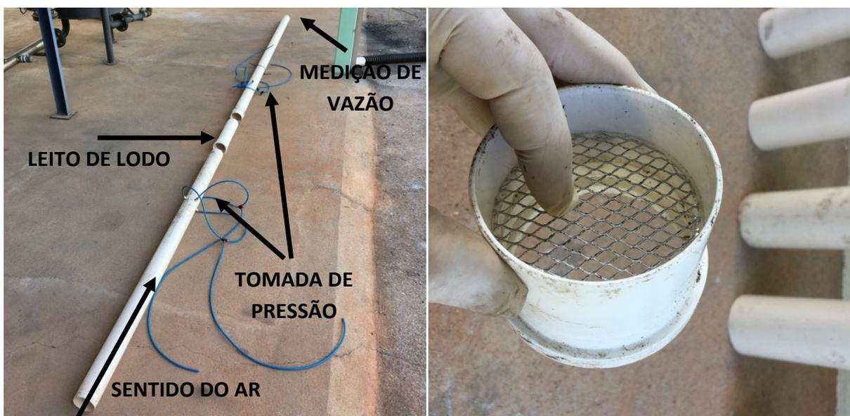
Figura 19: aparato de permeabilidade pré-montado (esquerda) e leito do lodo (direita).
