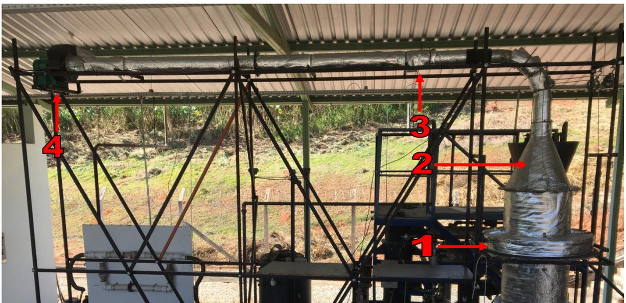
Figura 35: indicação do trecho de saída do ar de secagem: peça de fechamento do leito (1), tronco de cone (2), endireitador de fluxo (3) e exaustor de tiragem (4).
