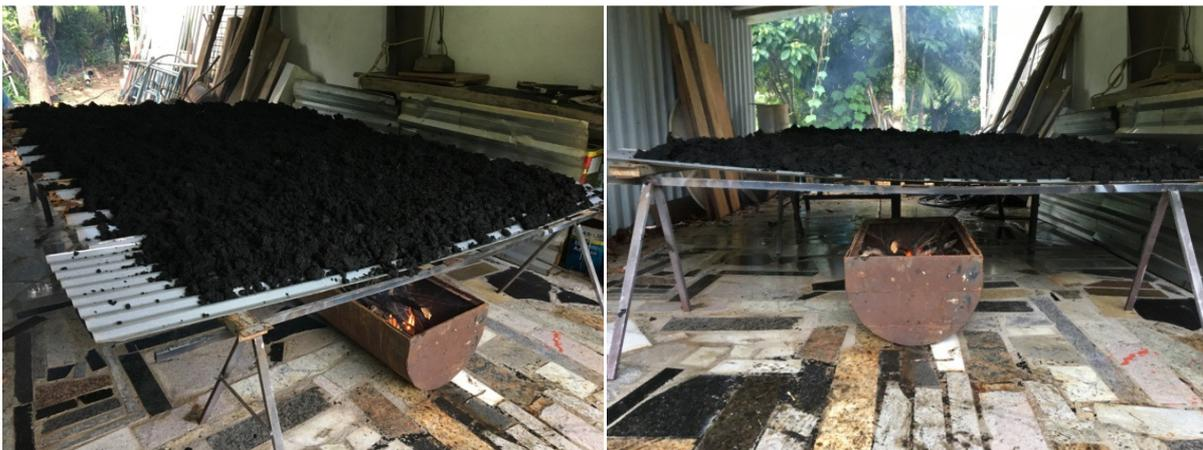
Figura 44: início da secagem do lodo sobre chapa aquecida e a calha parabólica sob o leito.
