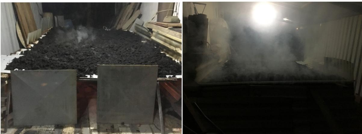
Figura 45: liberação de vapor d'água e fumaça durante a secagem sobre chapa aquecida.
