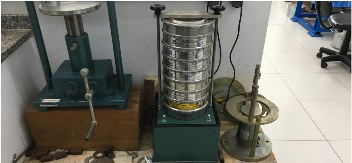
Figura 17: conjunto de peneiras com a base vibratória para o ensaio de granulometria.
