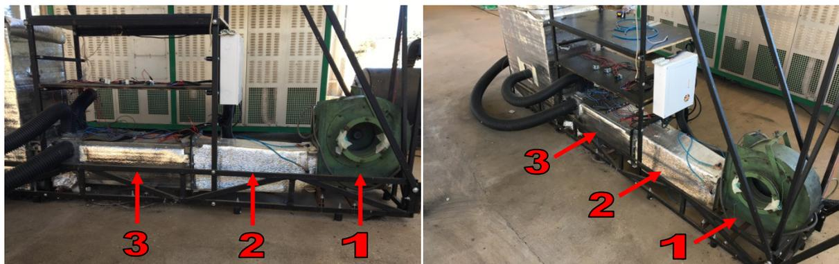
Figura 25: indicação do ventilador (1), duto de expansão (2) e duto de aquecimento (3).
