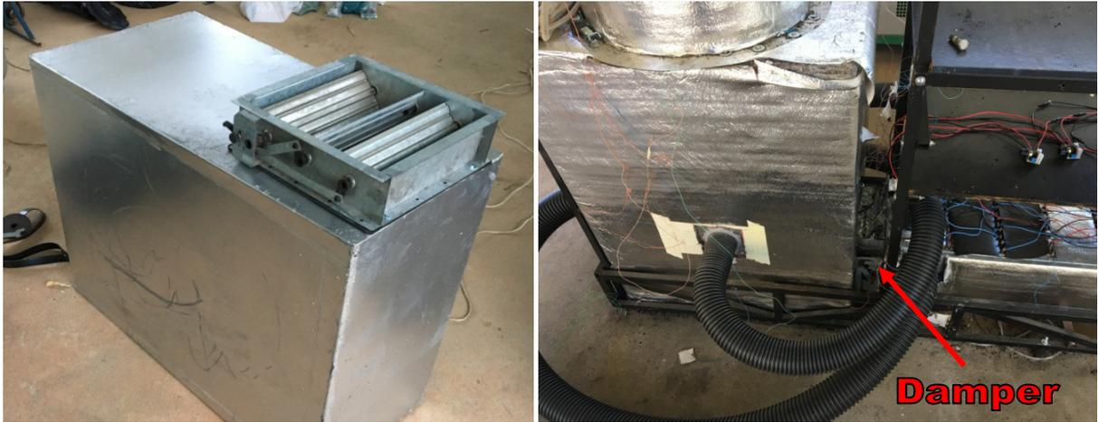
Figura 28: *damper* sendo montado na caixa de entrada (esquerda) e após a montagem (direita).
