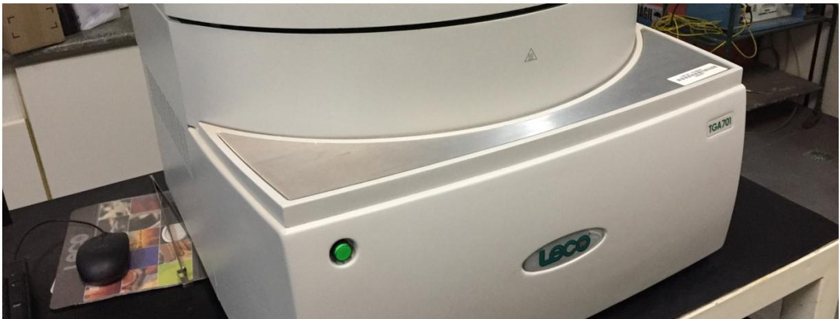
Figura 22: TGA que é utilizado para determinar as umidades e construir a curva de secagem dos lodos.
