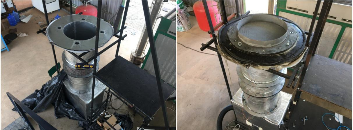
Figura 32: suporte do leito de secagem (esquerda) e leito instalado sem lodo (direita).
