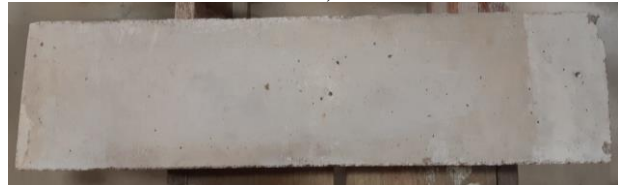
Gambar 7. Perubahan warna beton pasca pembakaran 750 °C (Sumber : Hasil Penelitian 2020)
