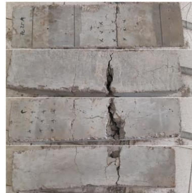
Gambar 10. Pola Retak Benda Uji 75B1 (Sumber : Hasil Penelitian 2020)
