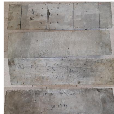
Gambar 8. Pola Retak Benda Uji BN1 (Sumber : Hasil Penelitian 2020)
