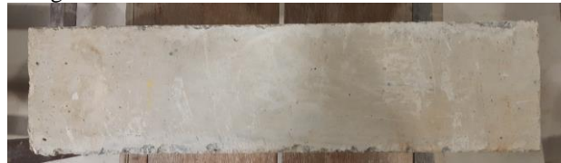
Gambar 6. Perubahan warna beton pasca pembakaran 500 °C (Sumber : Hasil Penelitian 2020)
