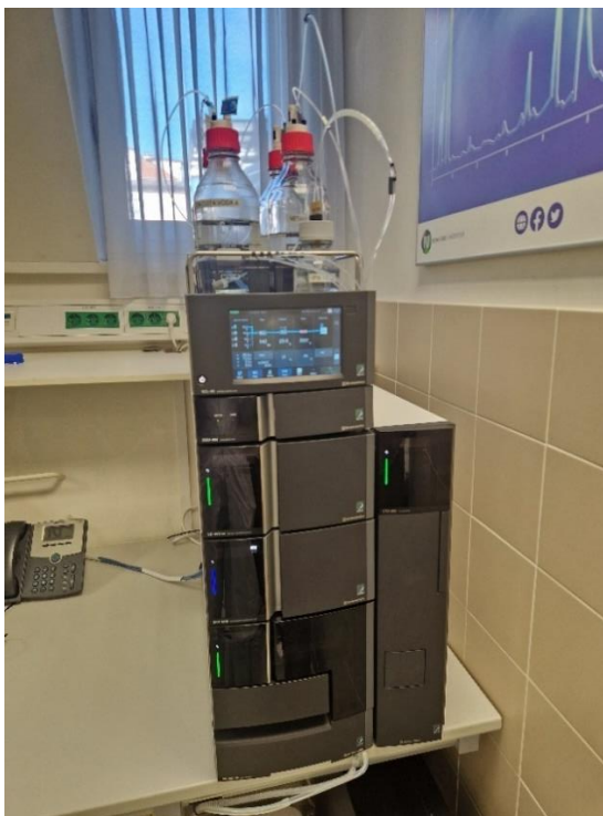
Slika 35: Sistem HPLC Shimadzu z avtomatskim vzorčevalcem (angl. autosampler ) (Shimadzu Scientific Instruments, ZDA)
