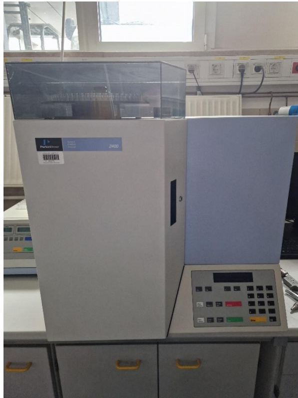
Slika 38: Analizator CHNS Elemental Analyzer 2400 Series II (Perkin-Elmer, ZDA)
