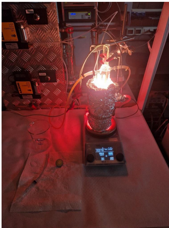
Slika 32: Reaktorski sistem za reakcijo razgradnje onesnaževal
