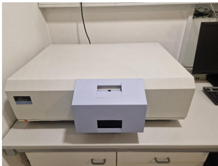
Slika 27: UV-VIS fluorescenčni spektrofotometer Perkin-Elmer LS 55
