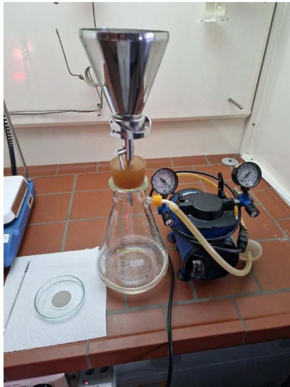
Slika 33: Postopek filtracije vzorca po končani fotosintezi
