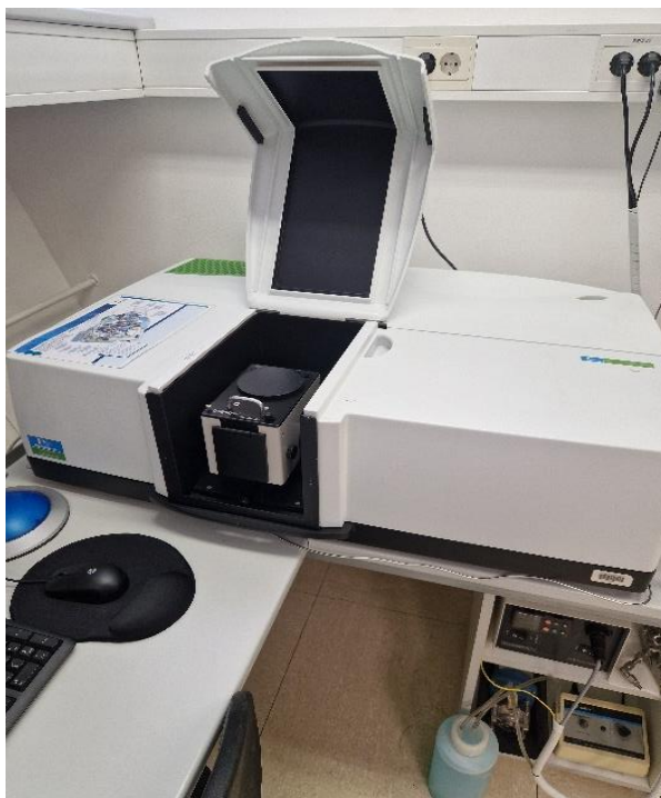
Slika 26: UV-VIS spektrofotometer Perkin-Elmer Lambda 650
