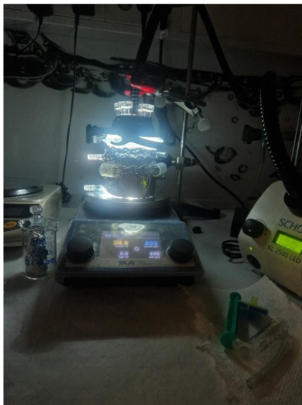
Slika 31: Reaktorski sistem pri eksperimentu za določanje tvorbe \text{O}_2^* in e^- v CB
