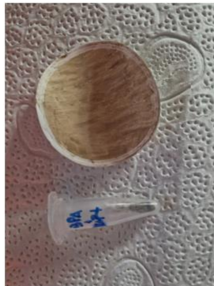
Slika 34: Posušeni filtrirni papir z vzorcem (levo) in filtrirni papir po odstranitvi vzorca (desno)
