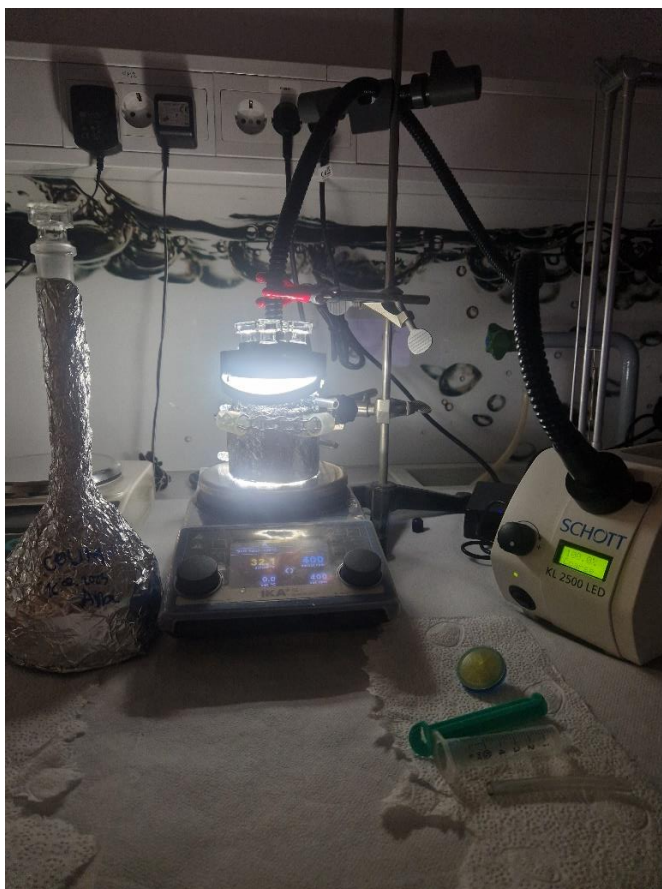
Slika 28: Reaktorski sistem pri izvedbi poskusa za določanje tvorbe \text{HO}^\bullet s kumarinom
