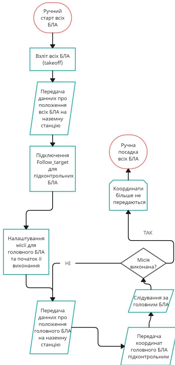
Рисунок 3.7 – Схематичне зображення тестового сценарію з MAVLink Follow
