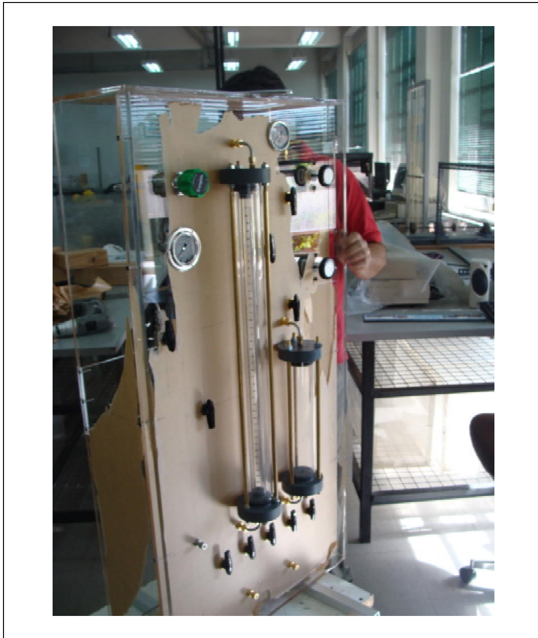
Fig. Anexo A.4.9.- Construcción panel equipo triaxial, 4.
