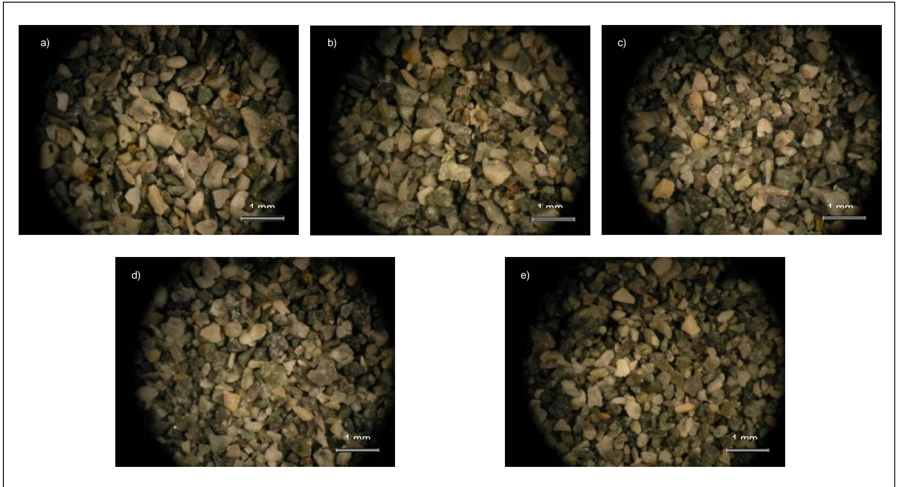
Fig. 5.41.- Ensayos Estáticos Arena Limpia. a) sin ensayar, b) 1 [kg/cm 2 ], c) 20 [kg/cm 2 ], d) 35 [kg/cm 2 ] y e) 50 [kg/cm 2 ]
