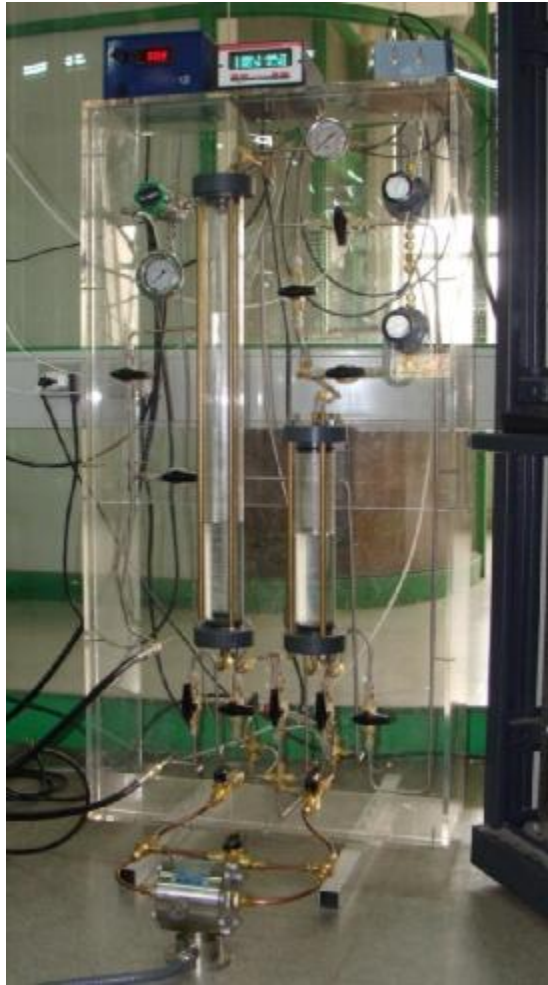
Fig. Anexo A.1.28.- Configuración calibración transductor de presión diferencial
