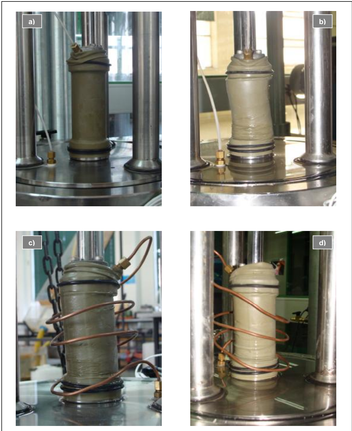
Fig. 5.21.- Imágenes ensayos estáticos: a) sin ensayar, b) 5 kg/cm 2 , c) 20 kg/cm 2 , d) 50 kg/cm 2 .
