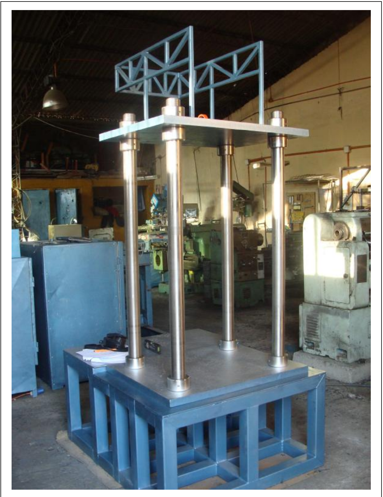
Fig. Anexo A.4.5.- Construcción marco de carga triaxial, 2.
