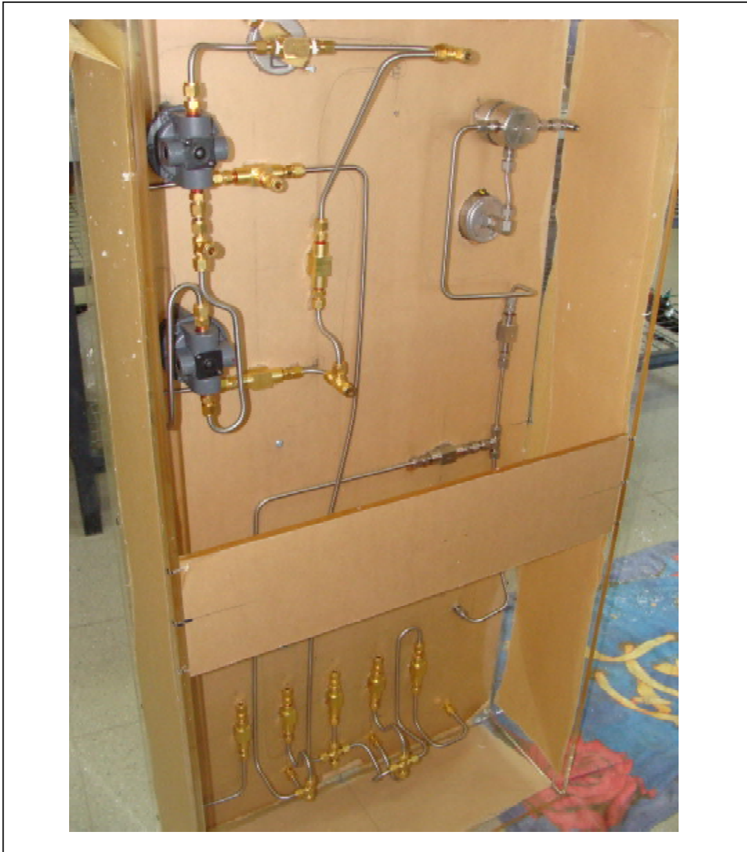
Fig. Anexo A.4.8.- Construcción panel equipo triaxial, 3.
