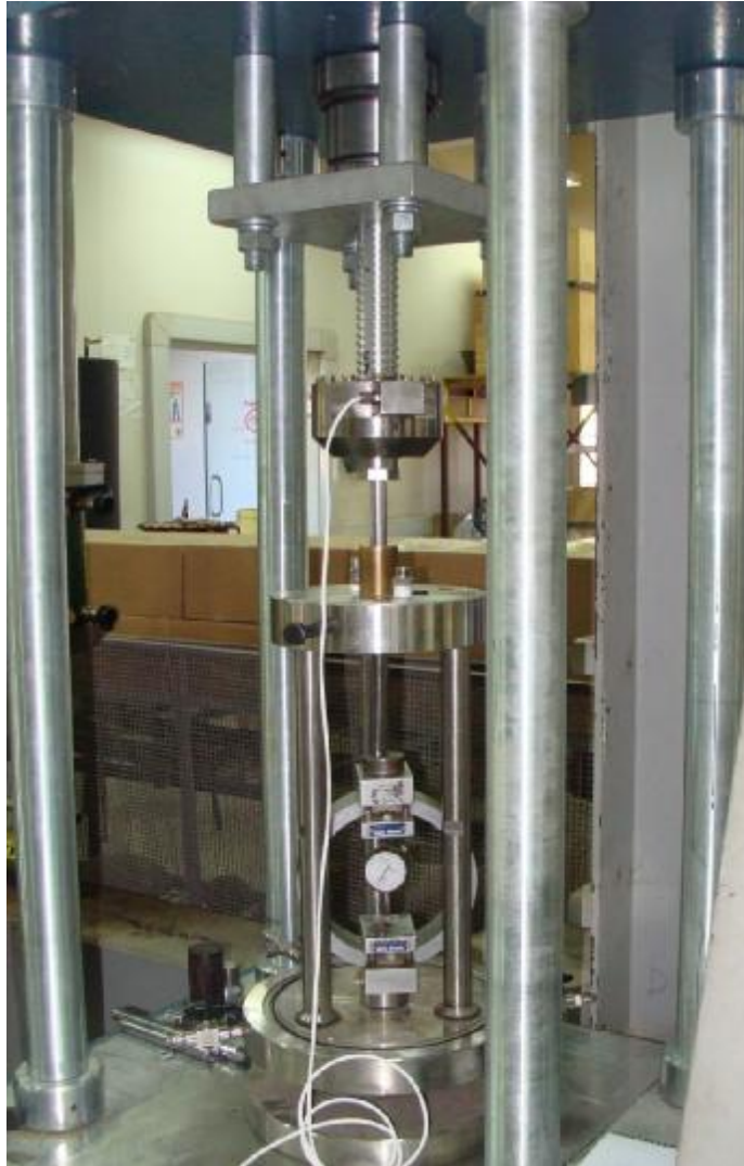
Fig. Anexo A.1.24.- Configuración calibración celda de carga externa
