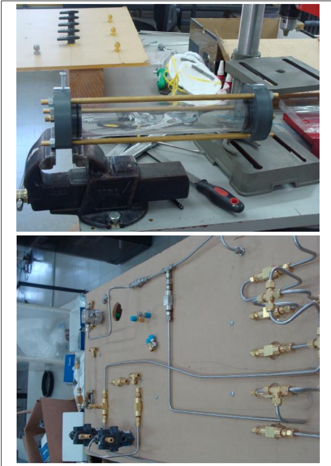
Fig. Anexo A.4.7.- Construcción panel equipo triaxial, 2.
