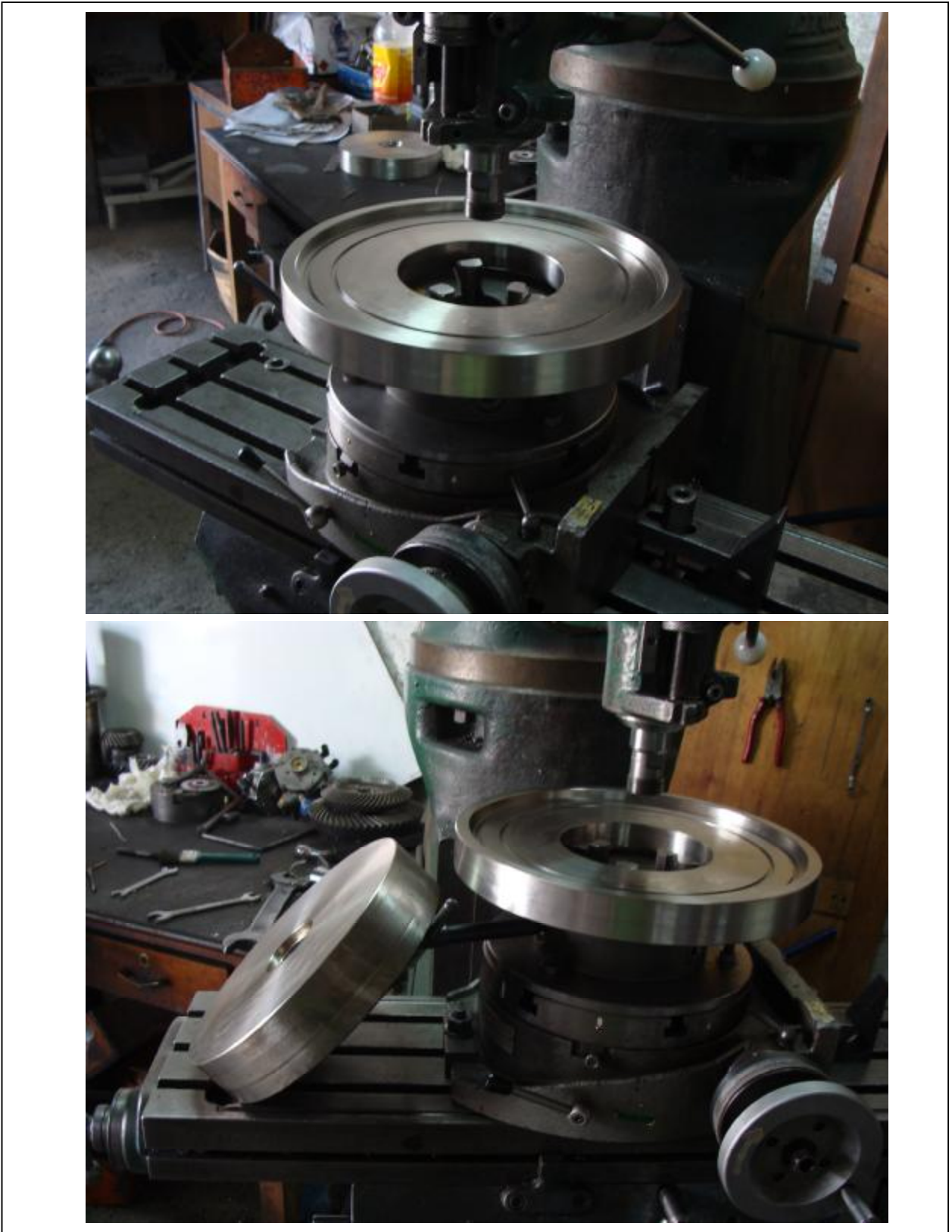
Fig. Anexo A.4.2.- Ejecución torneado piezas cámara triaxial, 2.
