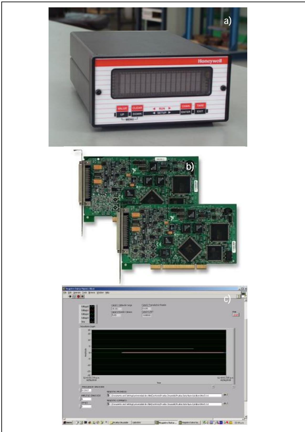
Fig. Anexo A.1.16.- Imágenes a) Acondicionador de señal. b) Tarjeta de conversión analógica digital. c) Interfaz programa de adquisición de datos
