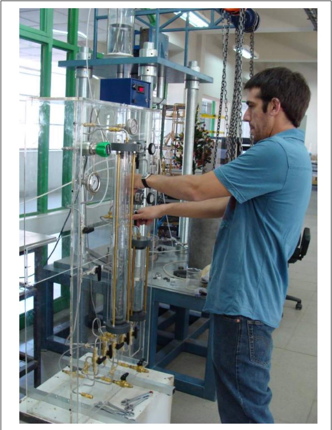
Fig. Anexo A.4.10.- Panel equipo triaxial en operación.
