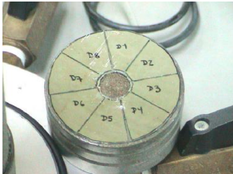
Fig. 4.2 Cabezales lubricados ensayos triaxiales. (Retamal, 2005)
