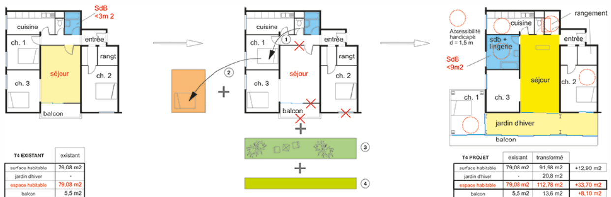
Figura 31. Proceso proyectual de la transformación. Torre La Chesnaie Elaboración: Philippe Ruault. Fuentes: web oficial Lacaton & Vassal
