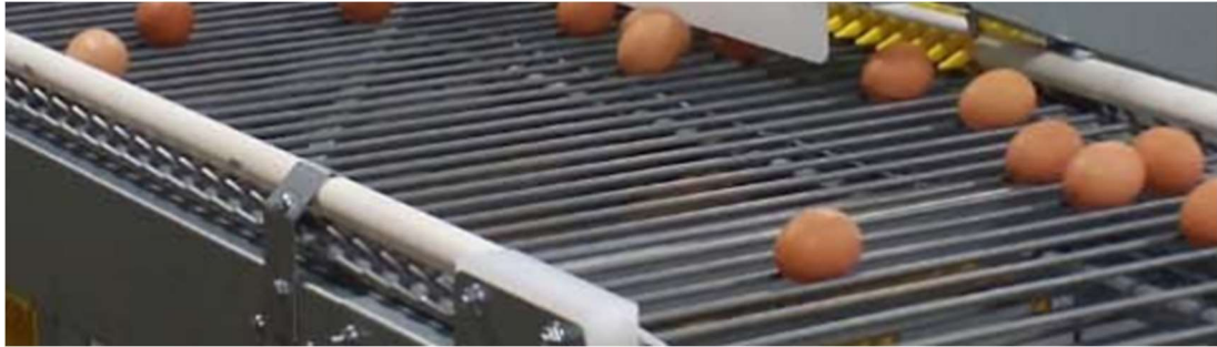
Ilustración 5 cinta de varilla
