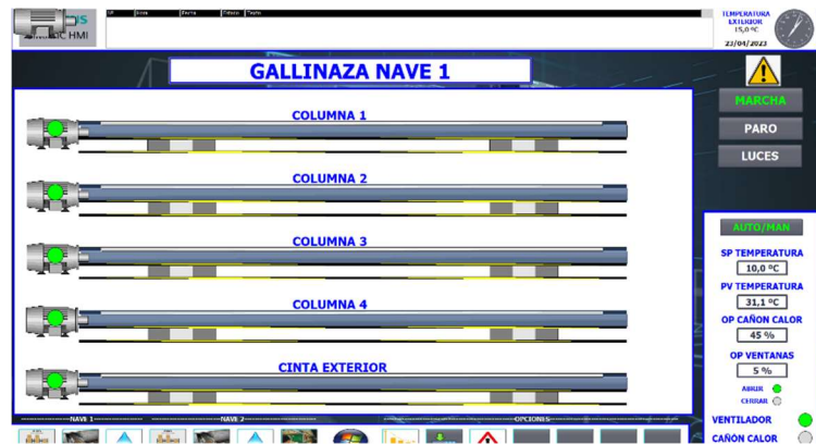
Ilustración 15 control temperatura nave 1
